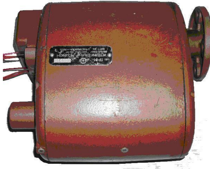
Рис. 2.6. Зовнішній вигляд електричного ВМ типу ПР-1М.
