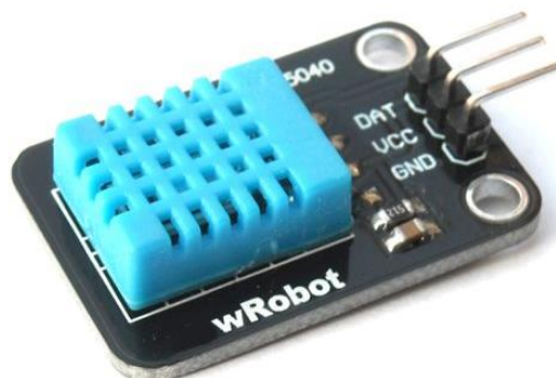
Рис. 2.4. Зовнішній вигляд датчика температури та вологості DHT-11.
