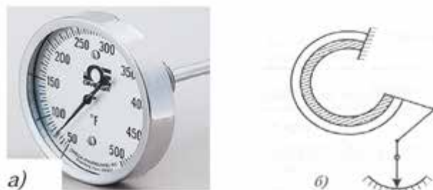
Рис. 9.11. Біметалевий термометр: а – зовнішній вигляд; б – біметалева пластинка
