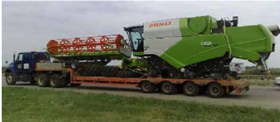
Рис. 2.6. Перевезення комбайна на низькорамному тралі-напівпричепі
