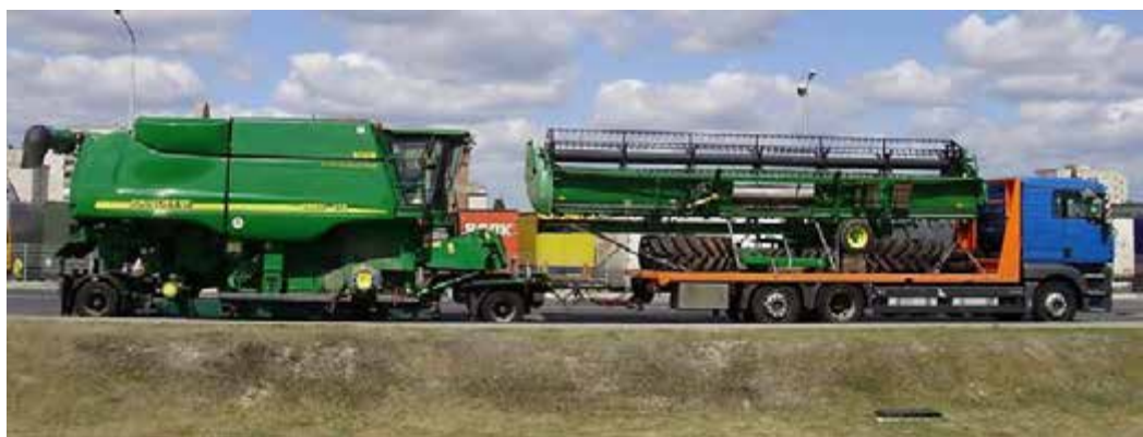
Рис. 2.7. Перевезення комбайна Джон Дір на триланковому автопоїзді
