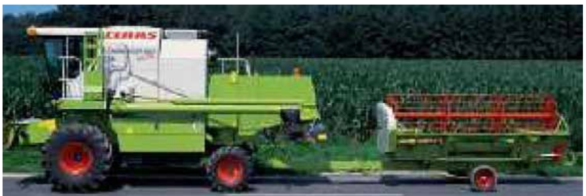
Рис. 3.5. Зернозбиральний комбайн Класс Домінатор в транспортному положенні
