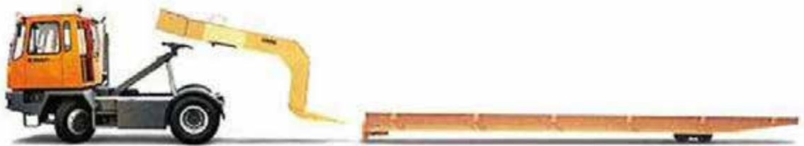
Рис. 1.1. Використання гузнека для зчіплення тягача з низькорамним тралом
