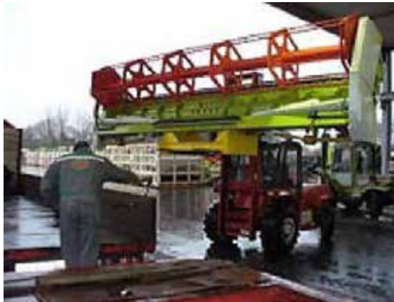
Рис. 3.15. Автонавантажувач при навантаженні жатки
