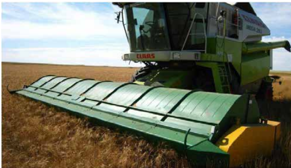
Рис. 1.4 - Зернозбиральний комбайн CLAAS MEGA 350 із жниваркою УАС
