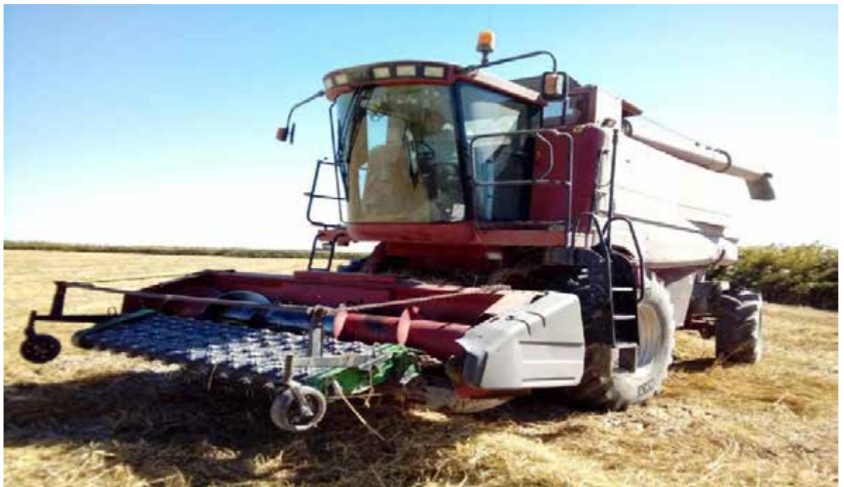
Рис. 3.1- Рисозбиральний комбайн CASE 2388 (США)
