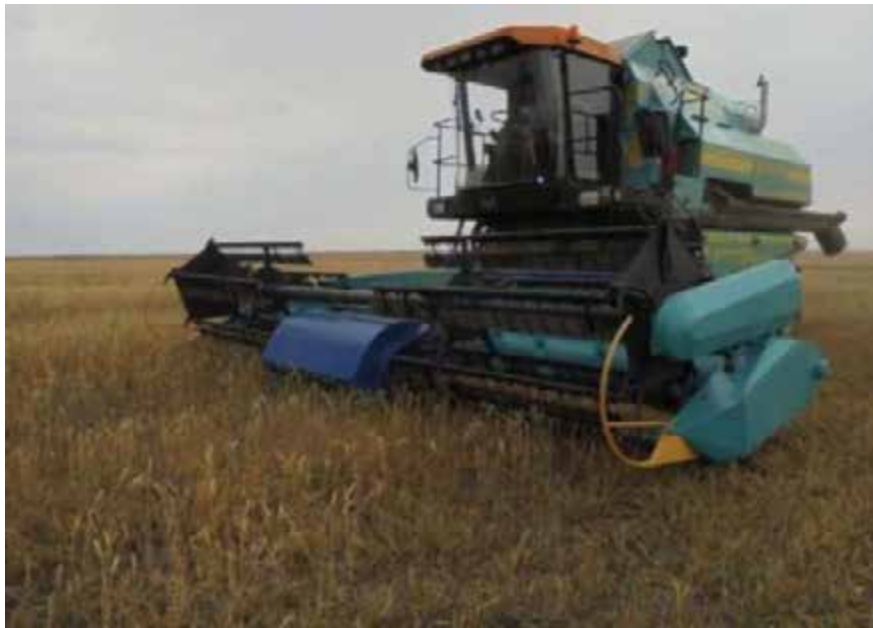
Рис. 1.5 - Зернозбиральний комбайн «Есіль-740» в агрегаті з хедером шириною захвату 7 м з адаптером, що очісує.
