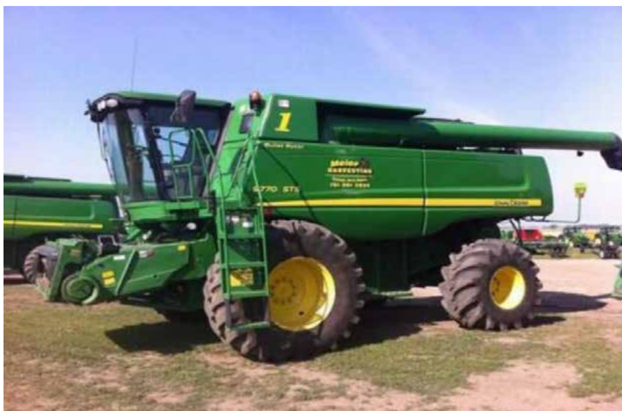
Рис. 3.3 - Рисозбиральний комбайн John Deere STS 9770 (США)
