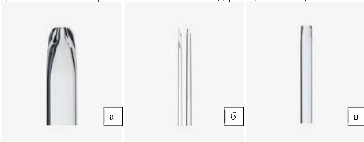
Рис. 5. Види мікропіпеток: а – мікропіпетка для холдінга; б – мікропіпетка для ICSI; в – мікропіпетка для біопсії.
