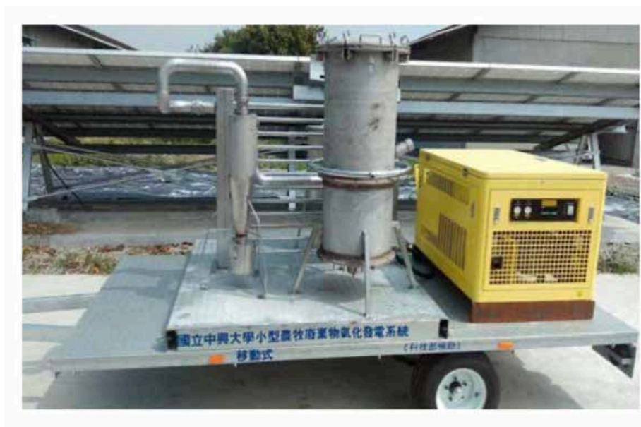
Рис. 3.2. Маломасштабна мобільна енергосистема на основі газифікації біомаси з низхідним потоком електроенергії потужністю 10 кВт [19]
