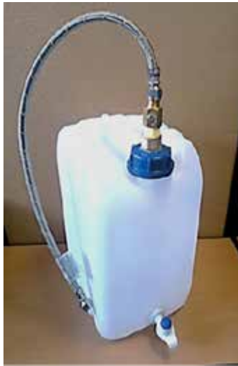
Рис. 4.1. Реактор, який використовується для спільного бродіння коров'ячого гною і залишків томатів.
