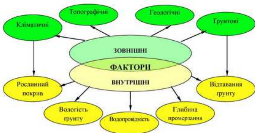
Рис. 2.2.2.6. Схема взаємозв'язків зовнішніх і внутрішніх факторів, що впливають на протнерозійну стійкість схилових ґрунтів.
