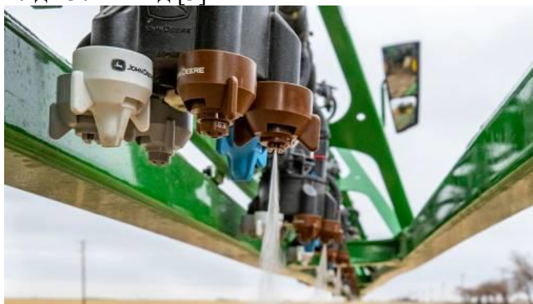
Рис. 2. Розпилювач оприскувача з технологією ExactApply [3].
