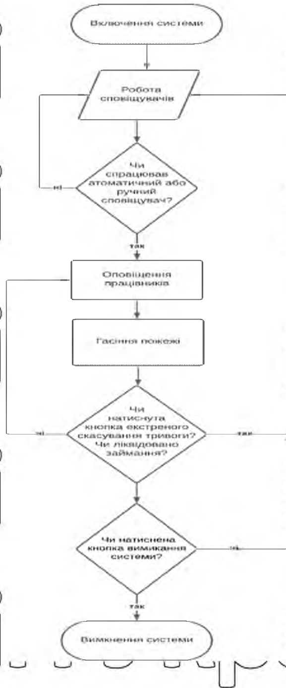
Рисунок 3.27. Приклад алгоритму роботи 1-зонної АСПБ
