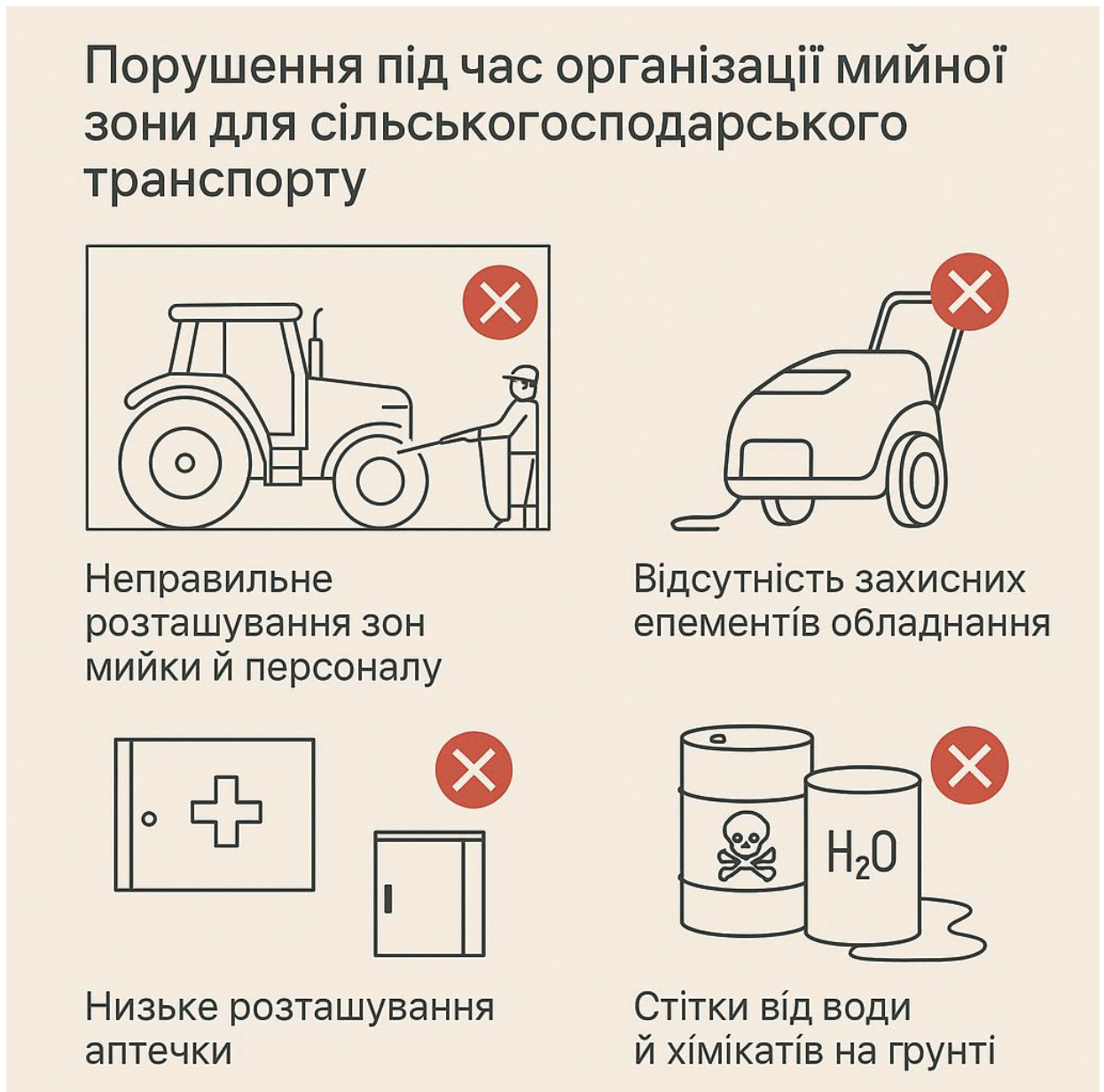
Рис. 3.3 – Типові порушення під час виконання мийних робіт і можливі наслідки для працівника
