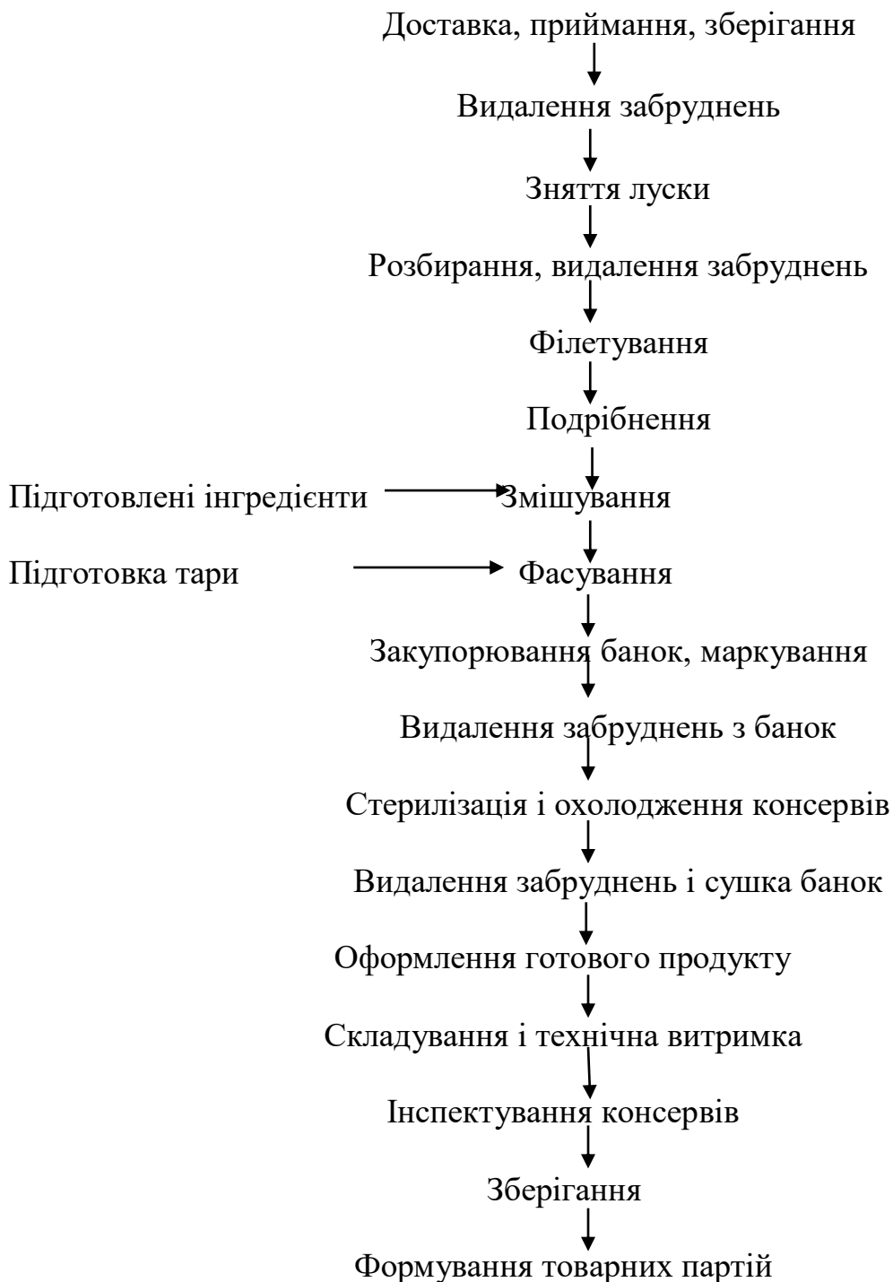
Рис.4.1 Принципова технологічна схема виробництва консервів «Голосіївські»
