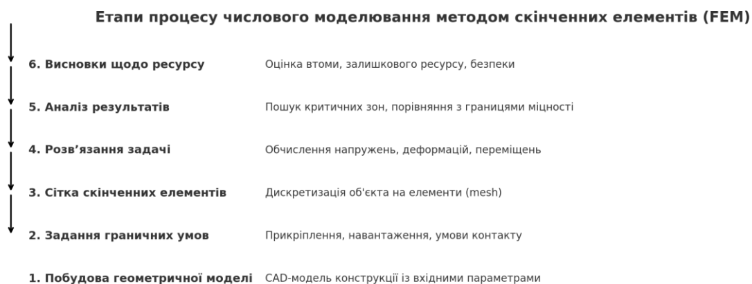
Рисунок 1.5 – Етапи процесу числового моделювання методом скінченних елементів (FEM)
