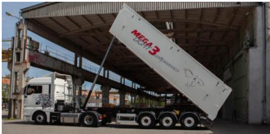
Рис. 2.3. Напівпричіп-зерновоз-самоскид Mega Light KBZ
