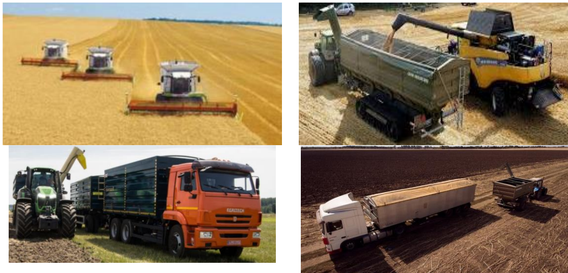
Рис. 2.4. Загальна схема перевантажувальної технології з використанням в якості компенсатора трактор з ПБН
