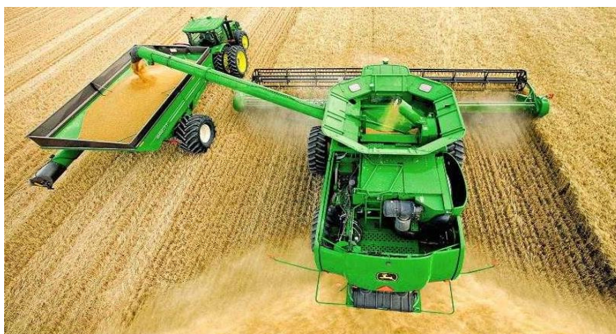
Рис. 1. Приклад порушення критичних відстаней: між шнеком комбайна і бортом ПБН і між правими колесами трактора з ПБН і лівим краєм жатки комбайна
