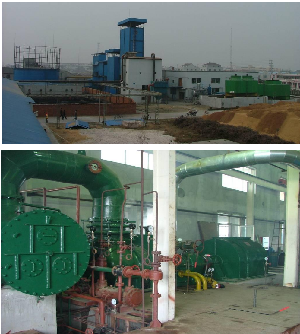
Рис. 2.4. Загальний вигляд заводу та схема технологічного процесу виробництва генераторного газу з аграрної біомаси вологістю до 30% з протипотоковим газогенератором потужністю 200 кВт (КНР) [43]
