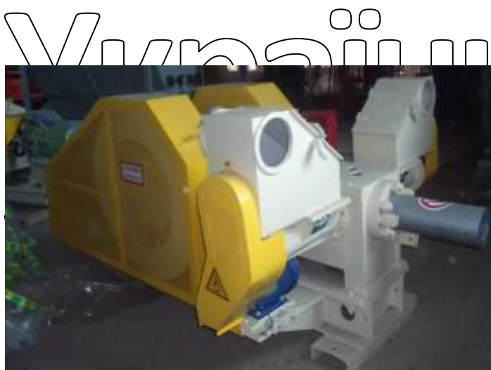
Рис. 1.6. Загальний вигляд перспективних брикетних машин виробництва України: а) - BEB-350 Bronto; б) - BEB-800
