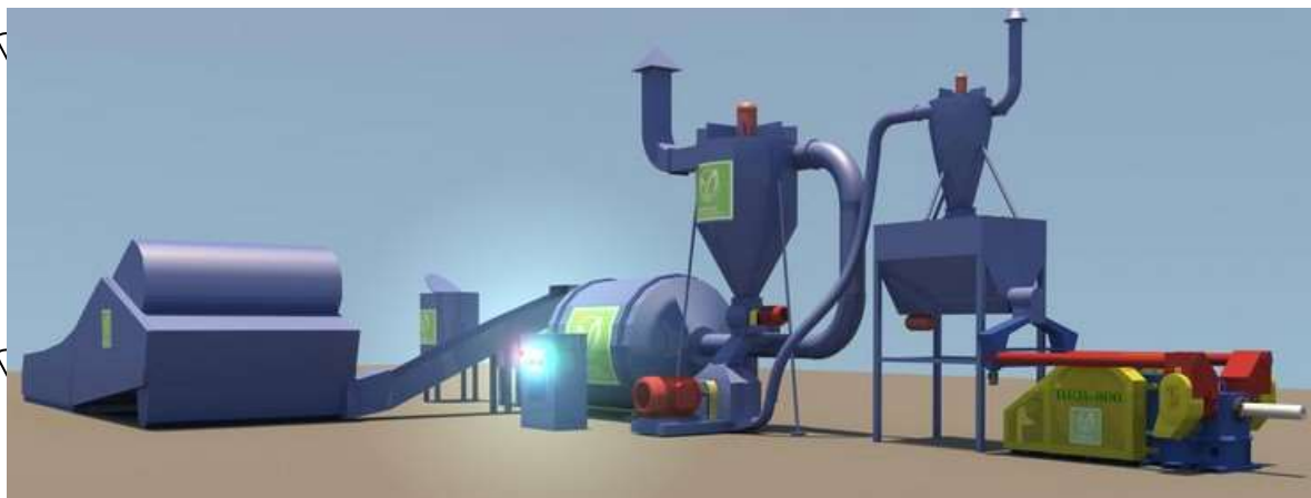
Рис. 1.7. Технологічна лінія виробництва брикетів на базі преса ВЕВ-800
