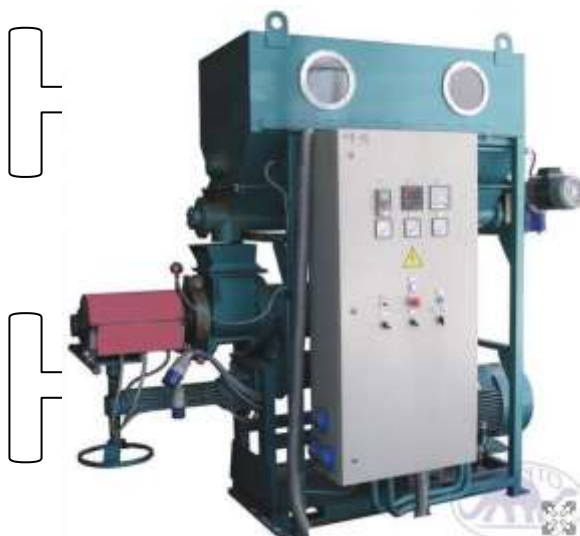
Рис. 1.6. Загальний вигляд перспективних брикетних машин виробництва України: а) - BEB-350 Bronto; б) - BEB-800
