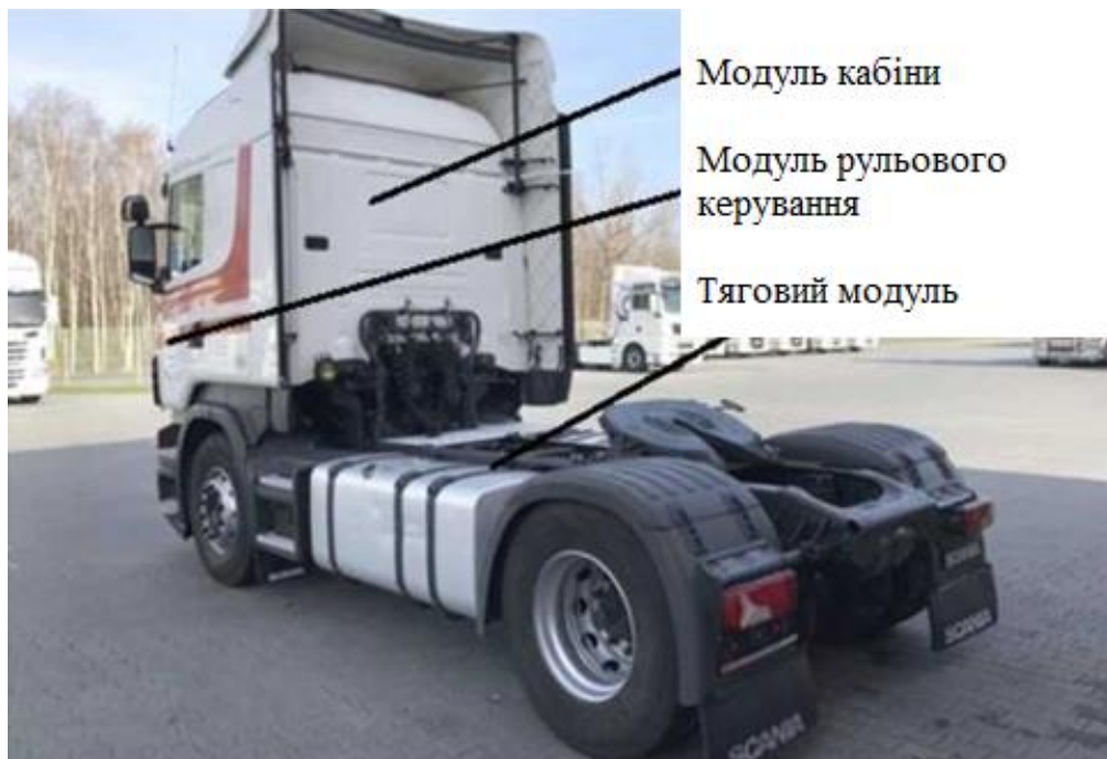
Рисунок 1.4 – Модульний автомобіль Scania
