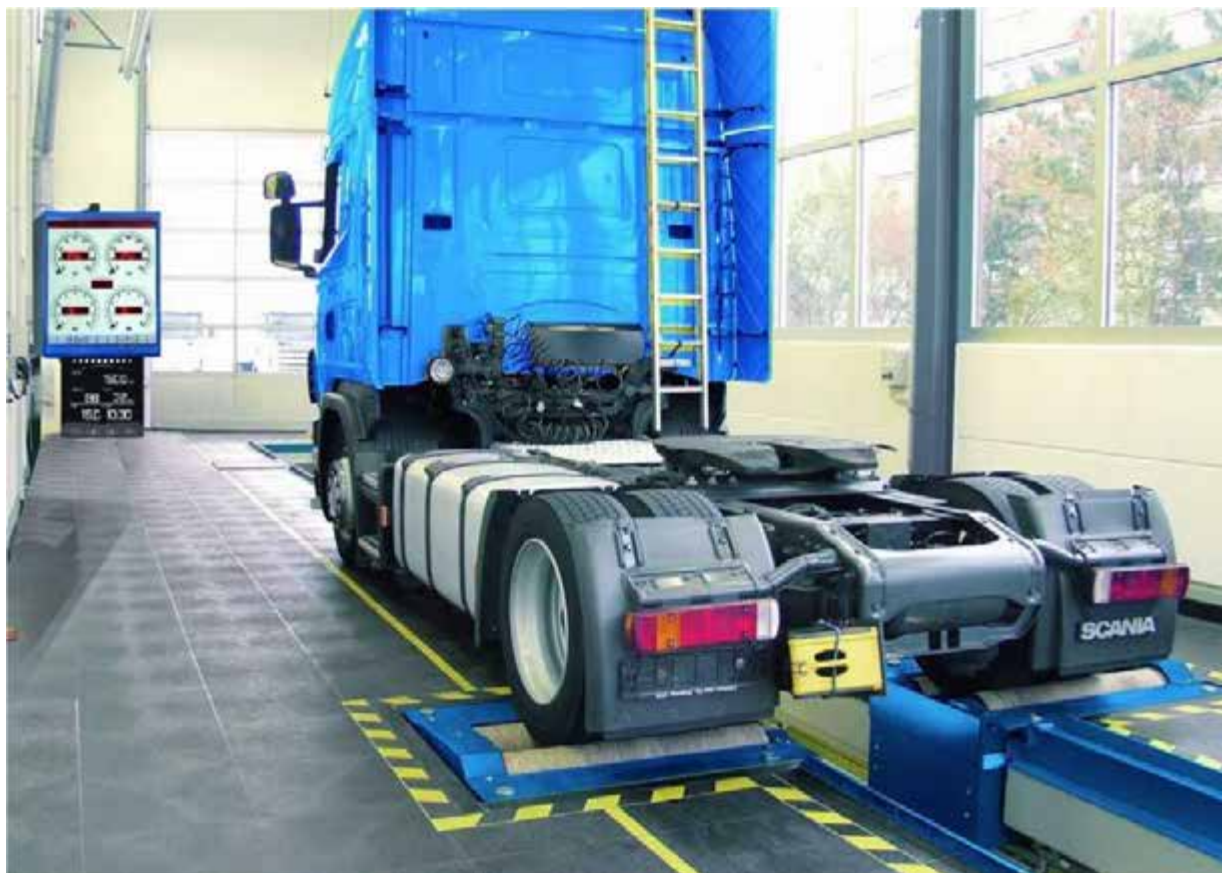
Рисунок 4.1 - Стенд контролю модуля MD 420
