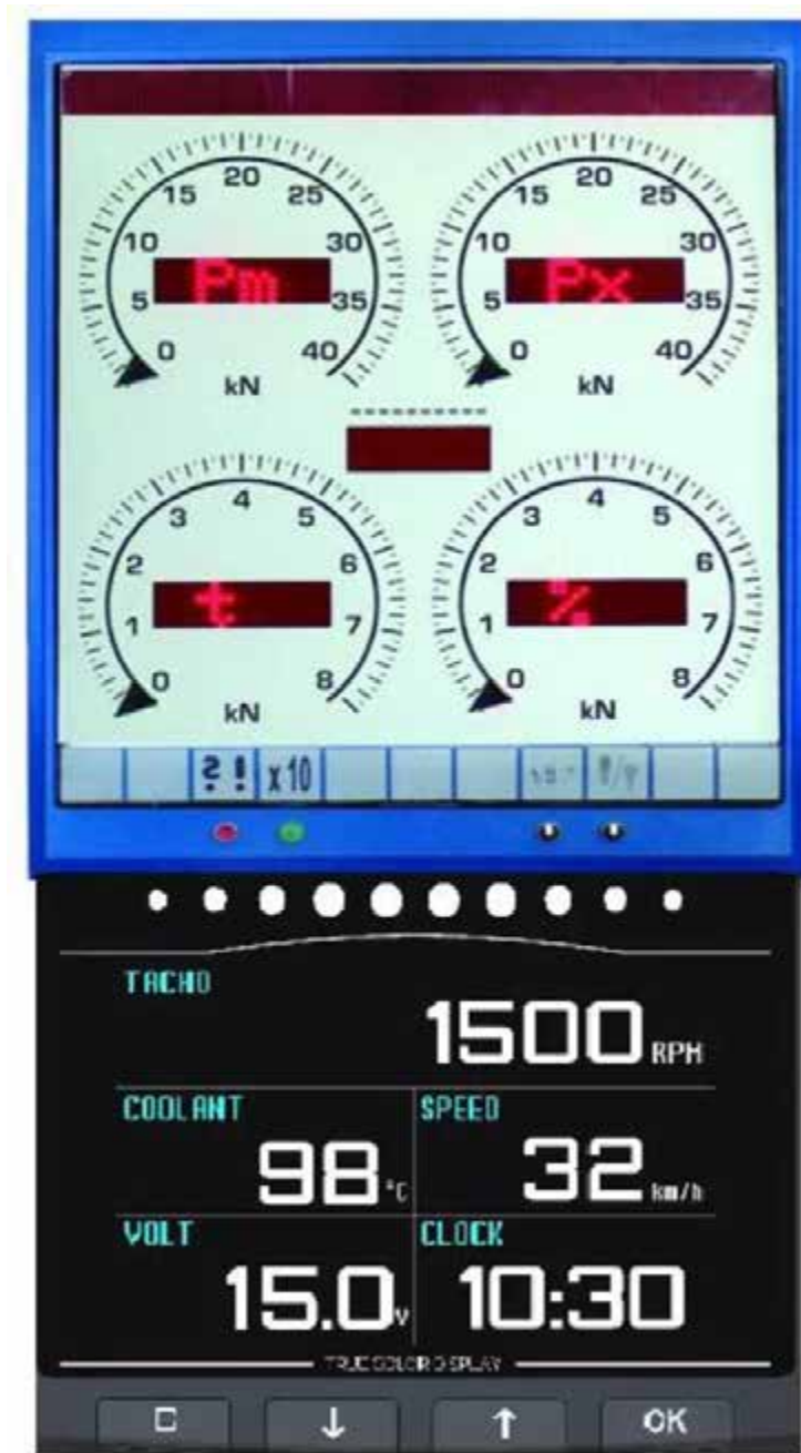
Рисунок 4.2 – Монітор стенду контролю модуля MD 420
