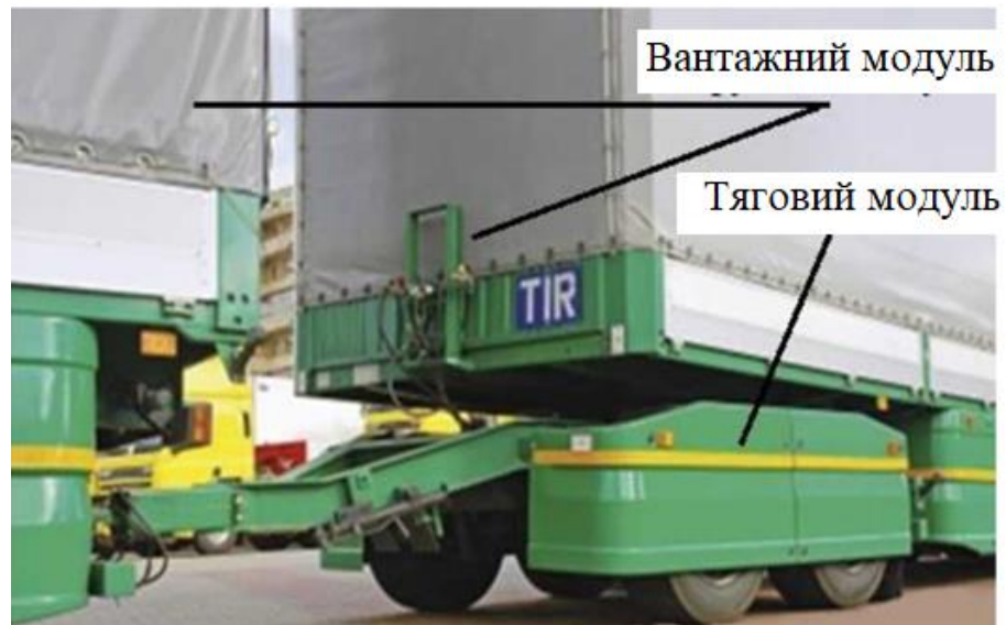
Рисунок 1.5 – Тяговий модуль з напівпричепом для Scania
