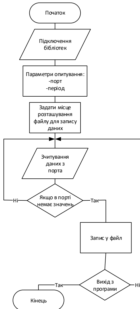
Рис. 6.3. Алгоритмізація процесу зчитування даних з COM порту
