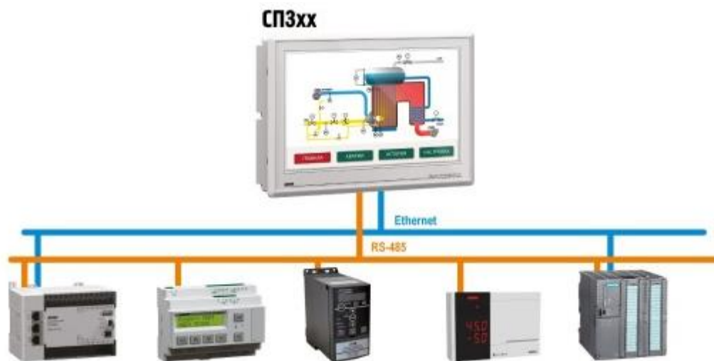
Рис. 6.2. Структура організації НМІ за допомогою СП310 AQteck
