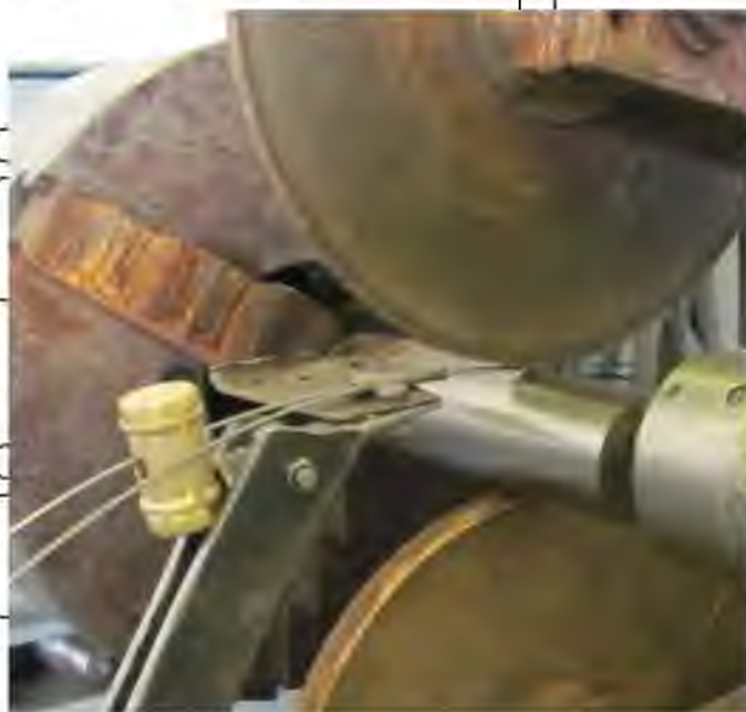
Рис. 3.3. Процес ЕКШ двох розтягнутих проволон
