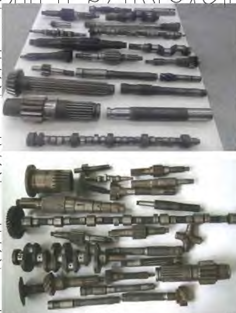
Рис. 3.1. Номенклатура відновлюваних деталей сільськогосподарської техніки
