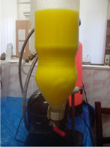
Рис. 3.4. Процес дослідження аерозольної промивки дизельного біопалива: 1 – суміш дизельного біопалива з водою; 2 – процес розпилення води над шаром дизельного біопалива
