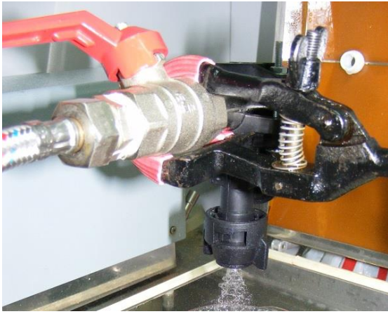
Рис. 3.2. Відцентровий повноконусний розпилювач марки "Disc and Core"
