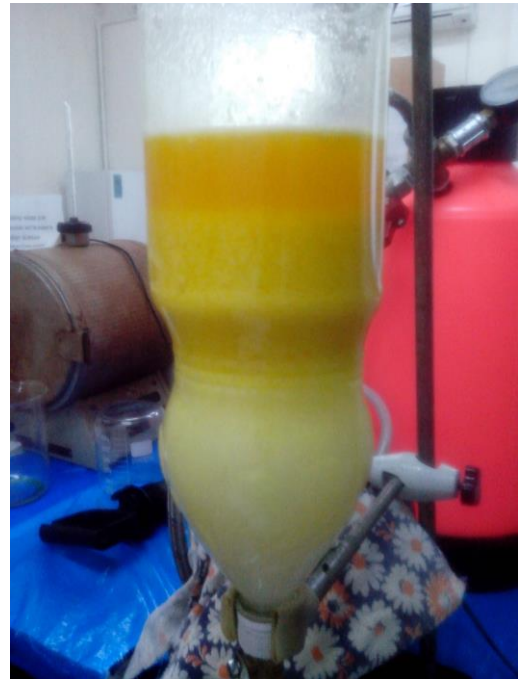
Рис. 3.5. Процес розшарування при аерозольній промивці дизельного біопалива: 1 – початок; 2 – закінчення
