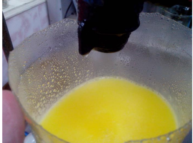
Рис. 3.4. Процес дослідження аерозольної промивки дизельного біопалива: 1 – суміш дизельного біопалива з водою; 2 – процес розпилення води над шаром дизельного біопалива
