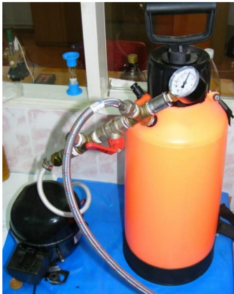
Рис. 3.3. Гідравлічний насос в складі компресора від холодильника і садового обприскувача
