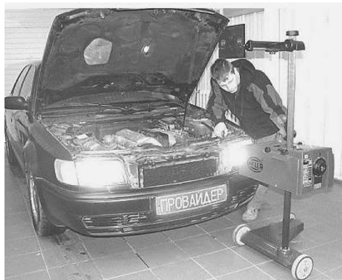
Рис. 6.33. Процес виконання перевірок та регулювань фар головного освітлення з залученням приладу типу ПФ-72 [50]
