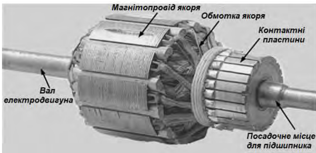
Рис. 7.11. Якір ДПС, який використовується на мобільній машині [73]
