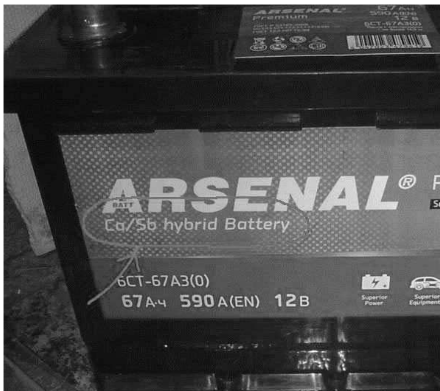
Рис. 2.8. Маркування на гібридній акумуляторній батареї
