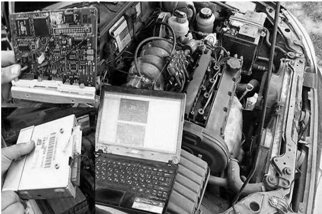
Рис. 4.59. Процес тестування і «перепрошивки» ЕБУ
