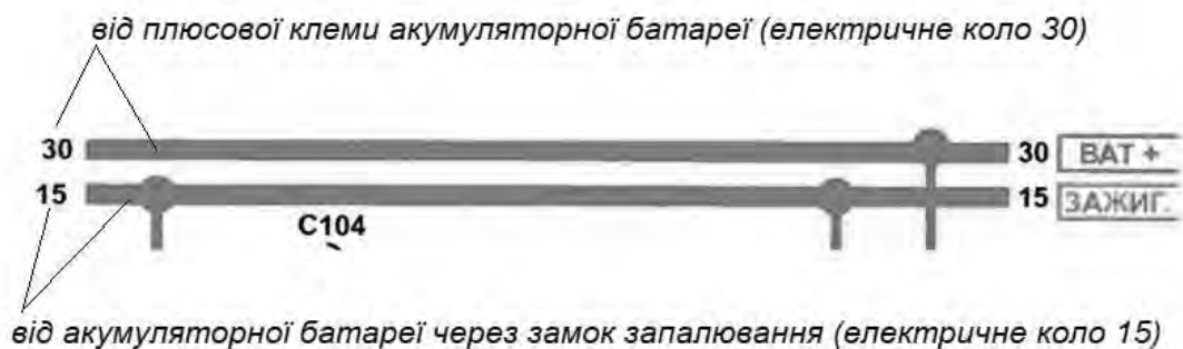
Рис. 1.15. Приклад позначення на електричній схемі ланцюга з плюсовим потенціалом [47]
