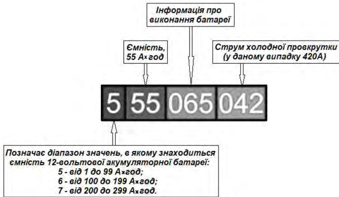
Рис. 2.26. Варіант маркування акумуляторної батареї за європейським стандартом [53]
