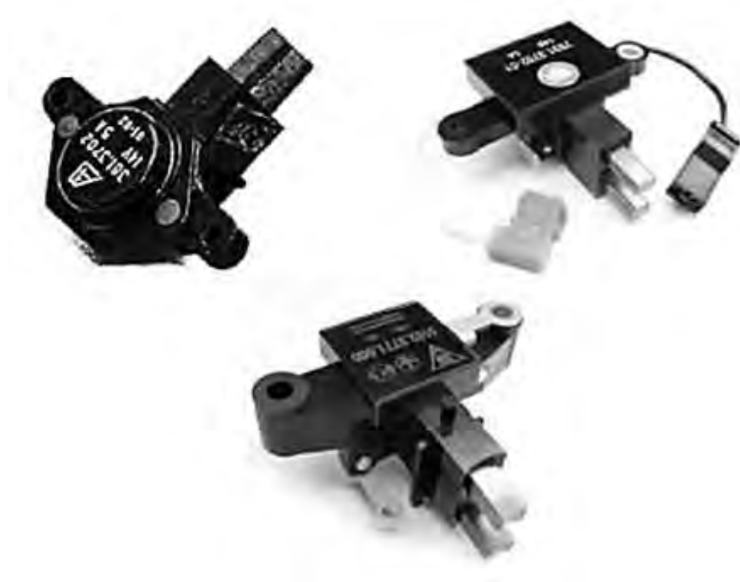
Рис. 2.87. Окремі різновиди регуляторів напруги об'єднані в одному корпусі з щітковим вузлом [49]
