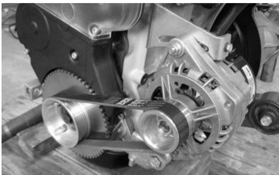
Рис. 2.66. Привід генератора пасовою передачею з поліклиновим пасом
