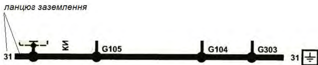
Рис. 1.16. Приклад позначення на електричній схемі ланцюга заземлення («маси») [47]
