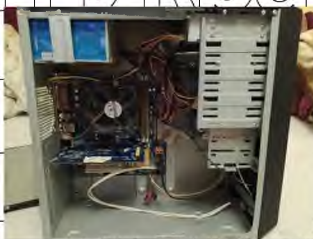
Рисунок 3.10- Встановлення плати збору даних L 783 фірми ЗАТ "ЛКАРД" в шину PCI 2.3 материнської плати комп'ютера
