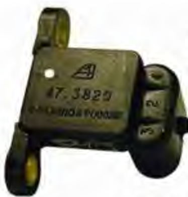
Рисунок 3.2- Датчик тиску наддува 47.3829
