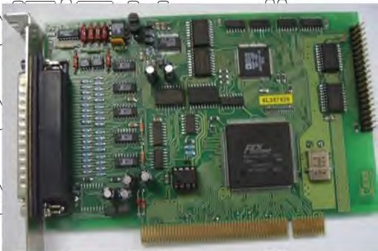
Рисунок 3.9 Плата збору даних L 783
