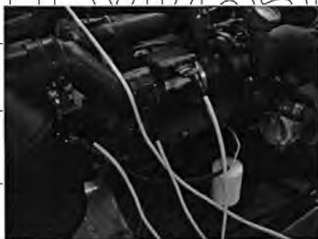
Рисунок 3.8 - Установка датчика HLM2-4.7 0280212014 та 45.3829 на впускному колекторі замість штатного перехідного патрубку
