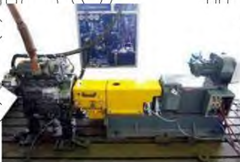
Рисунок 3.1 Обкаточно-гальмівний стенд КІ-5543
