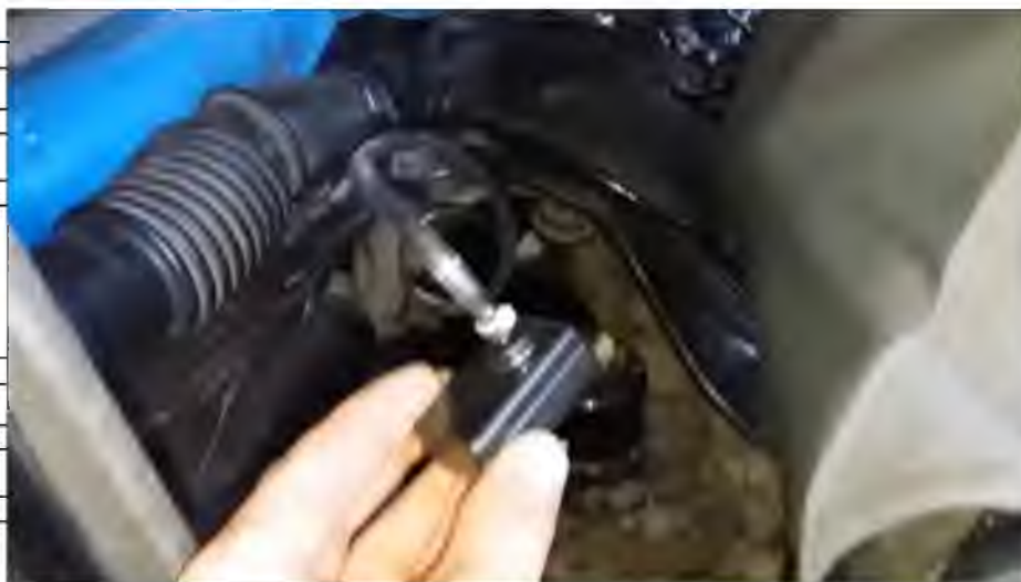
Рисунок 3.3-Монтаж датчика тиску наддува 47.3829 на впускний колектор двигуна
