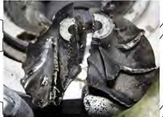
Рисунок 1.2 - Втомні тріщини на крильчатці турбіни з частковим руйнуванням лопаток внаслідок підвищеної вібрації та перекручування
