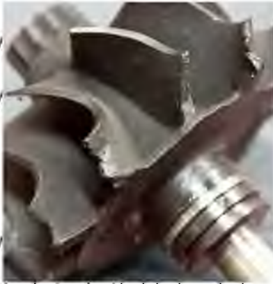
Рисунок 1.1 - Втомні тріщини на крильчатці турбіни внаслідок підвищеної вібрації та перекручування.
