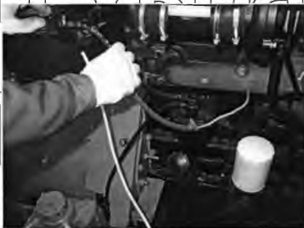
Рисунок 3.5-Монтаж датчика тиску випускних газів перед турбіною 47.3829 на випускний колектор двигуна Д245-35
