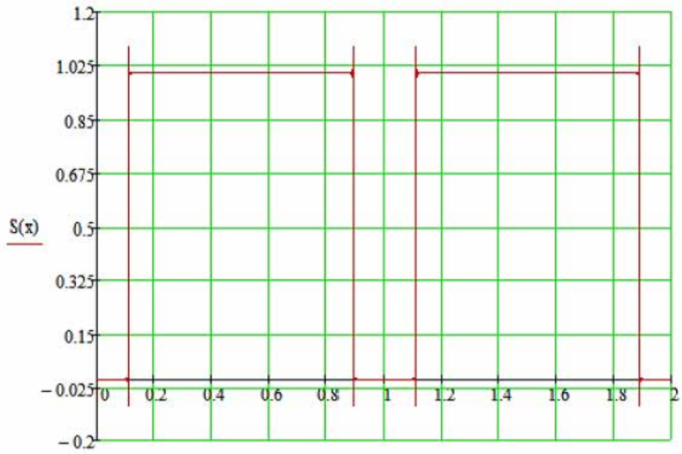
Рисунок 3.7. Взаємозалежність переміщення ножа від переміщення бурякозбирального комбайна
