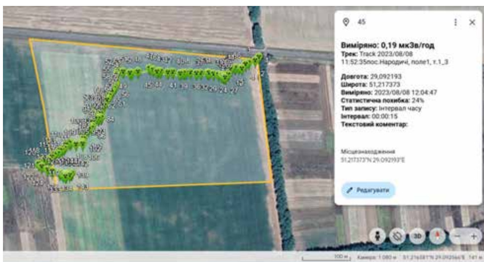
Рисунок 3.4. Поле №1, розташування точок вимірювання потужності еквівалентної дози \gamma -випромінювання
