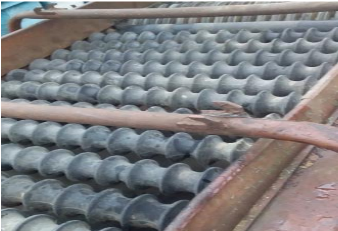
Рис. 2.17 Роликова сортувальна поверхня картоплесортувального пункту
