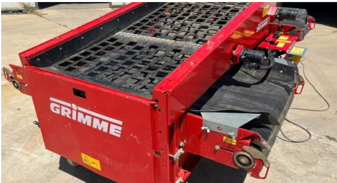
Рис. 2.15 Сортувалка Grimme із сітчастою сортувальною поверхнею
