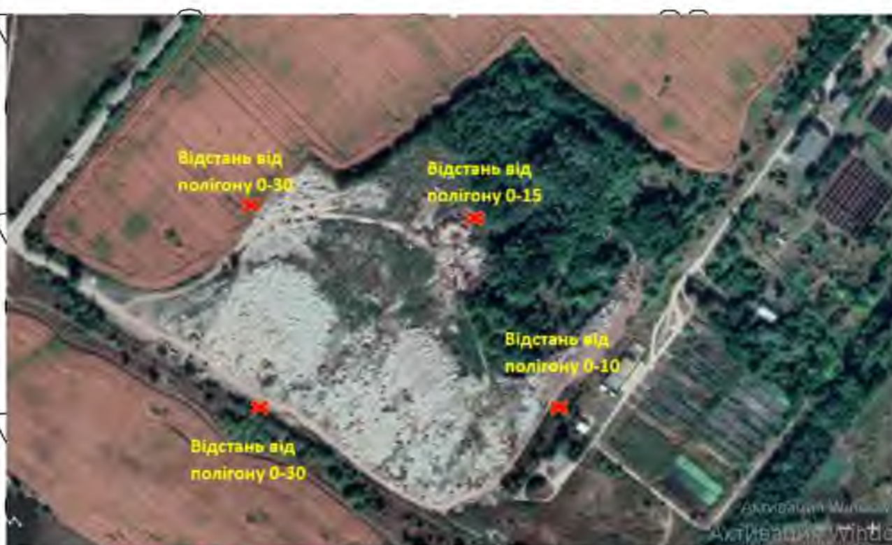
Рис.2.2.1 Схема відбору проб ґрунту на Прилуцькому полігоні твердих побутових відходів.
