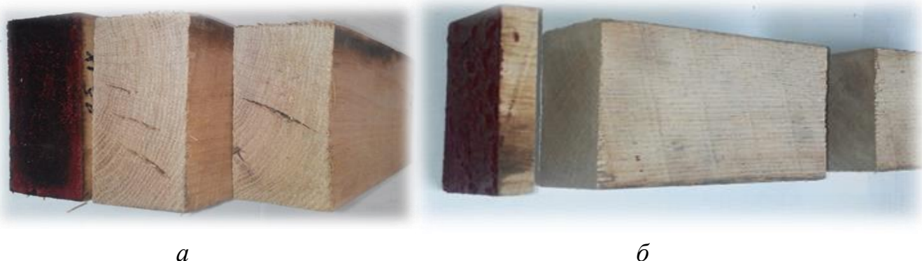
Рис. 9. Результат сушіння заготовок дуба звичайного, висушених за осцилювальними режимами: а – жорстким режимом № 1; б – м'яким режимом № 2.
