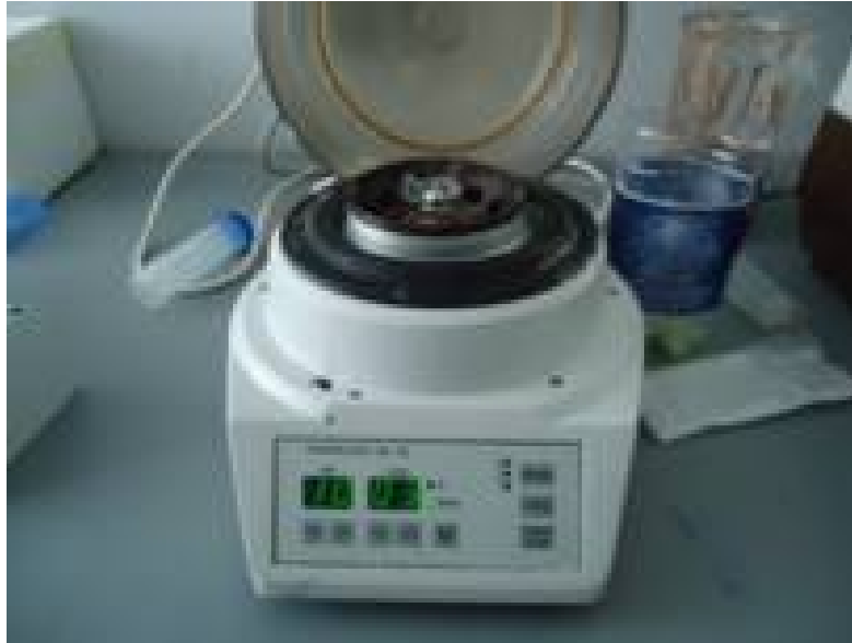
Рис. 3.43. Центрифугування крові у центрифугі при 3000 обертів для осадження еритроцитів
