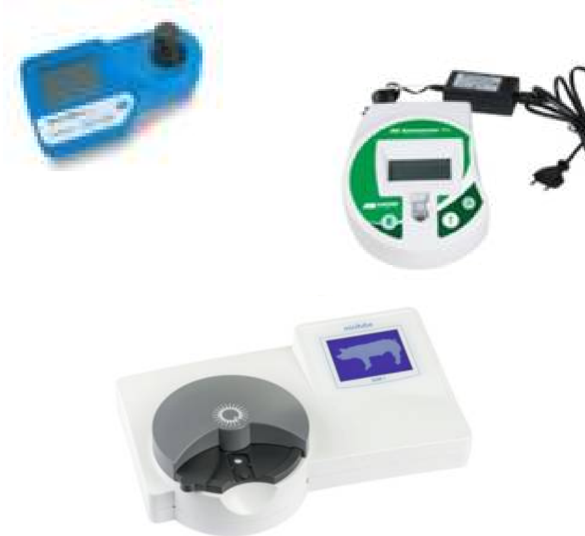
Рис. 6.19. Портативні фотометри для визначення концентрації сперми
