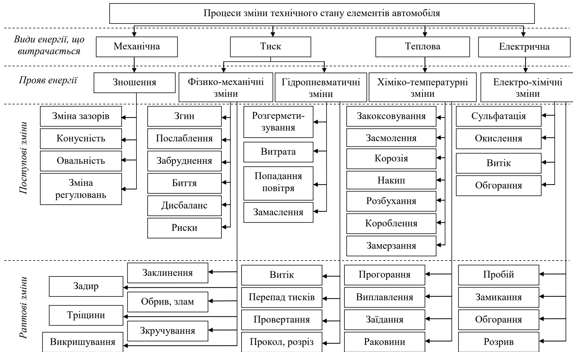
Рис. 1.1. Процеси зміни технічного стану елементів автомобіля
