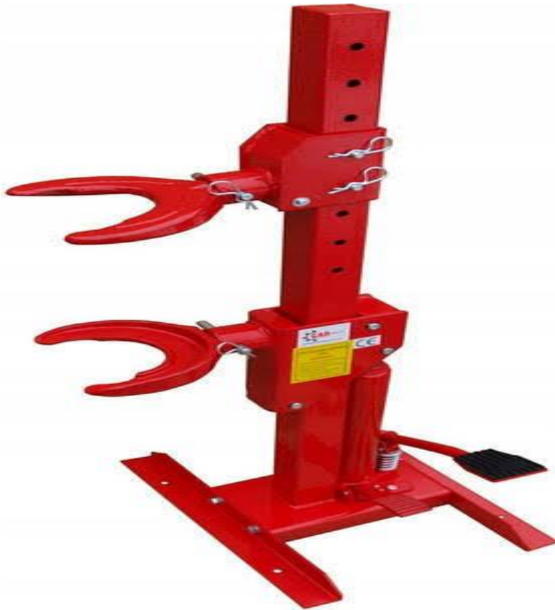
Рис 3.1. Загальний вигляд приспособи для розбирання амортизаційного вузла.
