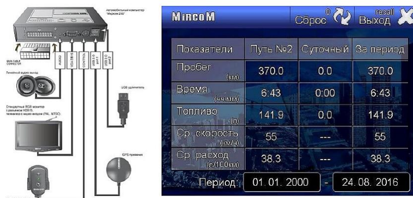
Рис. 2.1. Універсальна навігаційна система Мірком 200 (Mircom M200)
