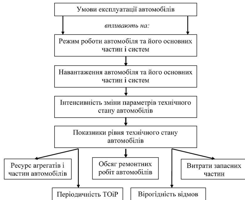
Рис. 1.3. Вплив умов експлуатації на інтенсивне зношування основних частин автомобілів
