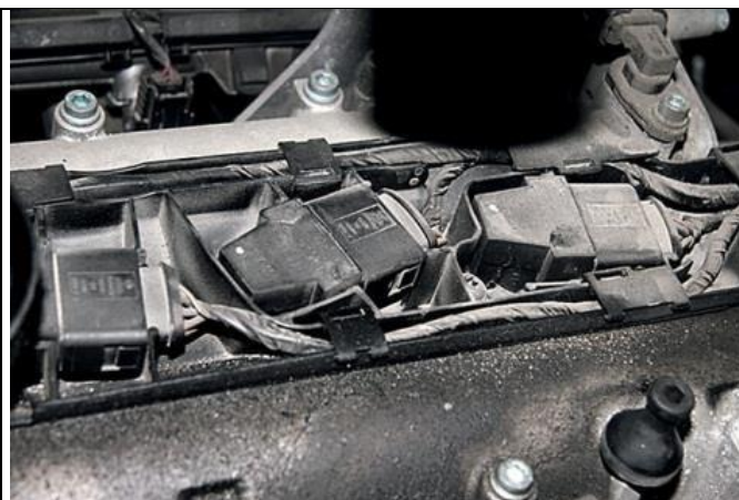
Рис. 3.1. Відмова індивідуальних котушок запалювання
