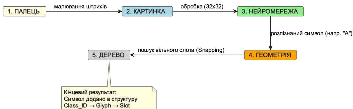
Рисунок 3.3 – Етапи попередньої обробки рукописного символу
