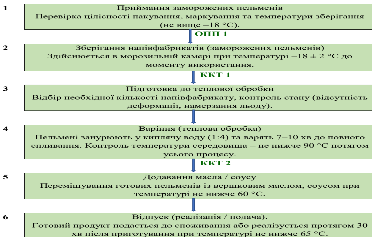
Рис. 3.4. Блок-схема технологічного процесу приготування пельменів з мороженого напівфабрикату.
