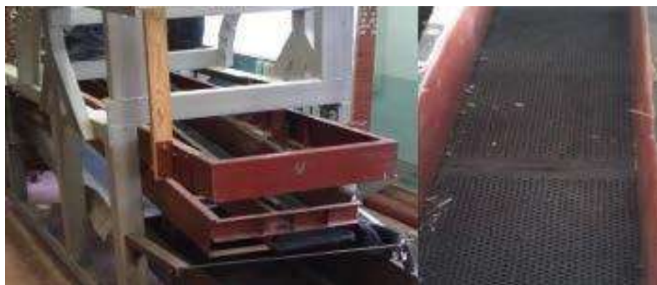
Рисунок 3.8 – Блок сходу основної фракції з решетами виготовленими з матеріалу ВМПЕ на одноповерховому решітчастому стані
