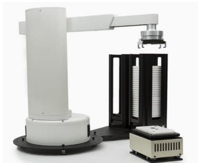
Рис 1.4. Цей циліндричний робот має один обертний призматичний шарнір.
