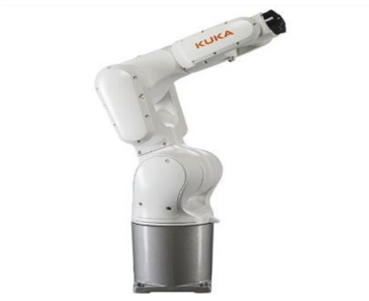
Рис. 1.8. Шестиосьовий шарнірний робот з повторюваністю поз \pm 0,02 мм.
