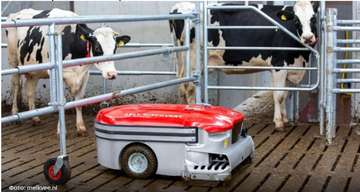
Рисунок 1.22 Lely Discovery 120 Collector — робот-прибиральник гною, має пристрої технічного зору завдяки яким легко орієнтується в корівнику.
