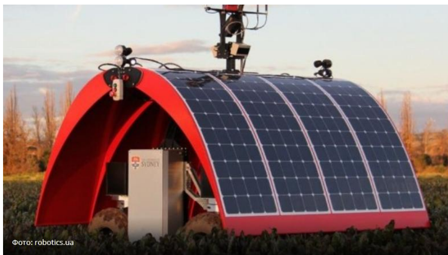
Рисунок 1.17 Сільськогосподарський робот-помічник Ladybird («Сонечко»). Заявленим завданням роботу є збір різних видів даних, що стосуються землеробства.
