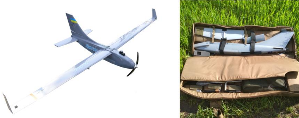
Рисунок 1.26 БПЛА літакового типу Spectator-M виробництва компанії Мерідіан ( http://merydian.kiev.ua/ ) у польоті (ліворуч) та у переносному кейсі (праворуч).
