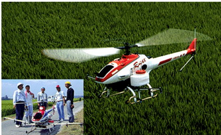
Рисунок 2.27. БПЛА Yamaha RMAX призначений для розпилення бакових сумішей. Може нести до 31 кг корисного навантаження. Вартість на початку 90-х років біля 100 тисяч $.
