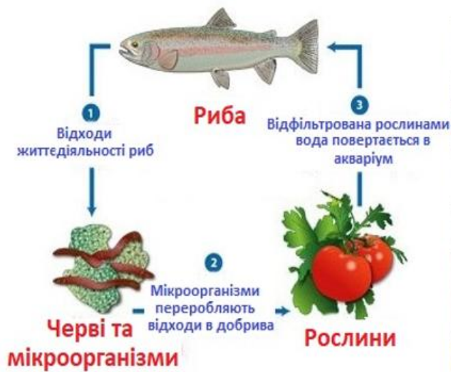
Рисунок 1.24. Схема аквапоніки (зліва) та фото діючої аквапонної ферми, де вирощують овочі та рибу (справа)
