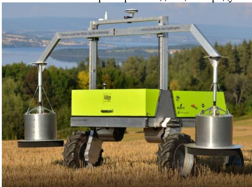
Рисунок 1.18 Adigo Field Flux — агроробот, який здатний проводити високоточний аналіз ґрунту і визначати кількість азоту ( N_2O ) на полі. Перевага всіх роботів для моніторингу полягає в їх здатності працювати цілодобово, аналізуючи стан полів. Ця інновація спрощує життя не лише фермерам,
