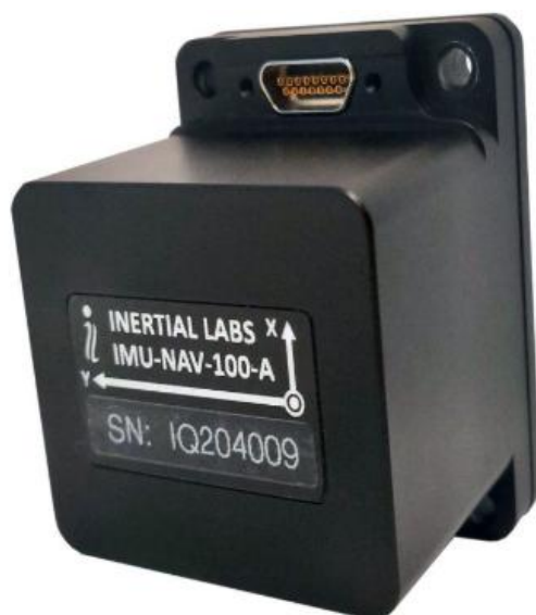
Рисунок 2.11. Інерціальний блок IMU-NAV-100 компанії Inertial Labs (США). Вихідні сигнали системи: прискорення, кутові швидкості, вертикальний кут, кут крену, відносний курс, температура. Частота оновлення даних — до 2000 Гц. Час запуску системи <1 секунди. Вага – 100 грам.
