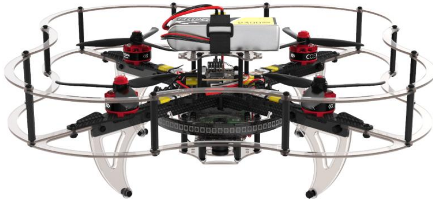
Рисунок 2.36. Квадрокоптер Клевер із інтегрованим бортовим моноплатним комп'ютером Raspberry Pi
