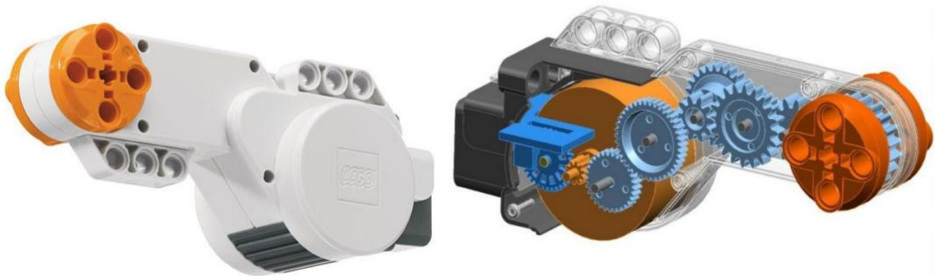
Рис. 3.4.17. Сервопривод (зліва) і його внутрішнє улаштування (справа)
