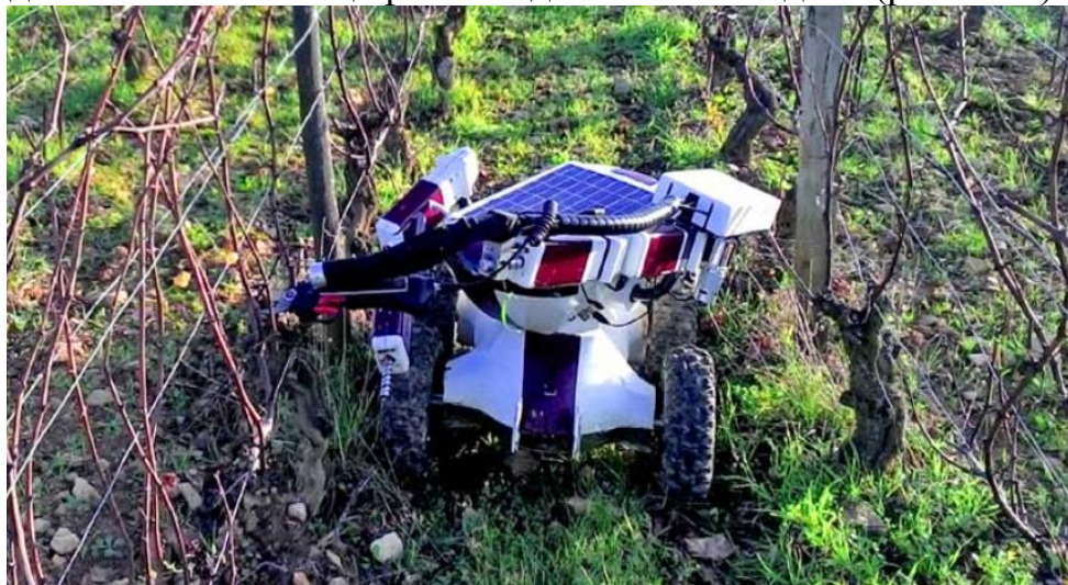
Рисунок 1.13 Сільгоспробот для роботи на виноградниках Wall-Ye V.I.N. (розробка Крістофа Майлота). Робот призначений для обрізки виноградної лози і видаленню непродуктивних пагонів а також збору інформації про локацію, кількість та якість плодів
