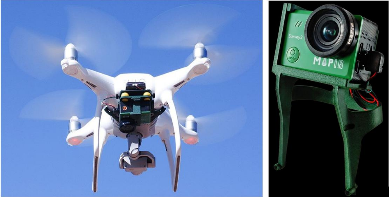
Рисунок 1.28 Сенсор Survey3 , встановлена на квадрокоптер DJI Phantom 4 (зліва) та на модулі підвісу (справа)
