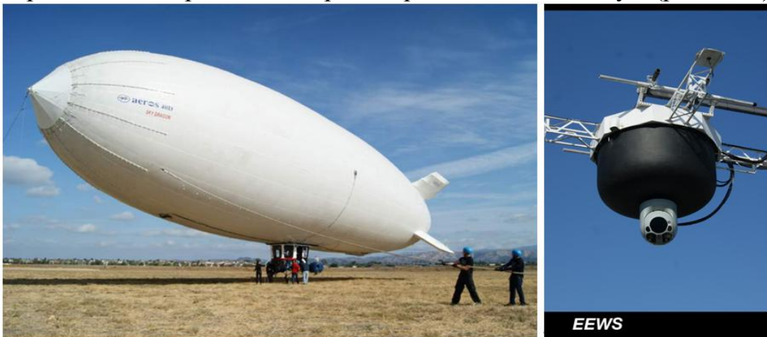
Рисунок 1.29 БПЛА Sky Dragon (зліва) та його комплекс сенсорного обладнання EWS NADATS (справа)
