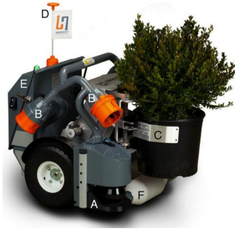
Рисунок 1.15 Робот HV-100 від компанії «Harvest Automation» (США). Робот створений для переміщення контейнерів з саджанцями, здатний виконувати операції по проріджуванню і збору рослин в розсадниках або теплицях ( https://public.harvestai.com/ ).
