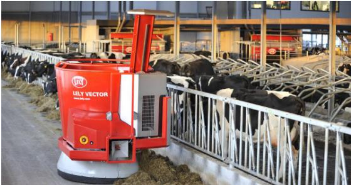
Рисунок 1.21 Робот-кормороздавач Lely Vector (Нідерланди). Бункер цього робота вміщує до 600 кг корму. Інтелектуальне програмне забезпечення дозволяє змішувати корми, розподіляти їх та підсувати ближче до тварин.
