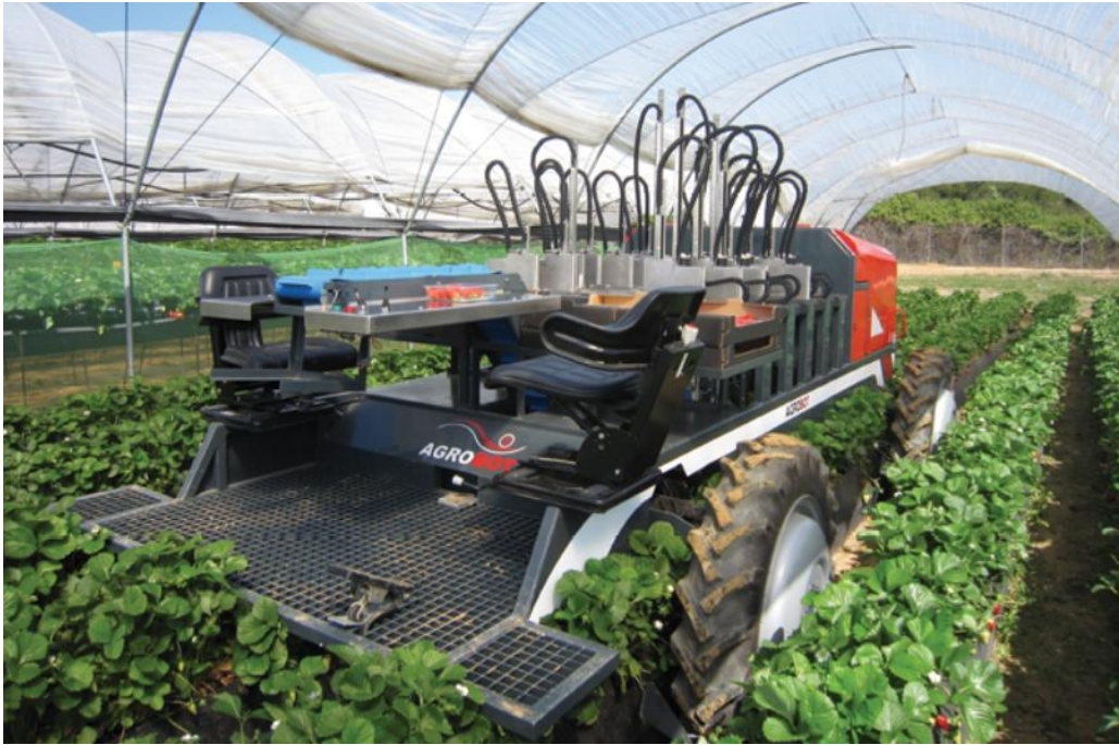
Рисунок 1.12 Робот для вирощування та збирання врожаю суниць садових Agrobot SW6010 (Іспанія). Роботизована рука перебирає по одній ягоді. За три дні один робот «Agrobot» може зібрати полуницю з 800 соток. Він забезпечує на 50% зниження ціни свіжих ягід і здешевлення до 90% сировини для промислового виробництва ягідного пюре і наповнювачів для йогуртів.
