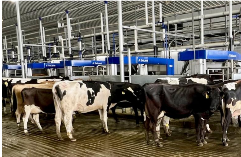
Рисунок 1.19 Робот дояр від компанії Delaval . Система забезпечує контроль якості молока та моніторинг стану здоров'я корови за допомогою датчика, прикріпленого до вуха або шиї тварини.
