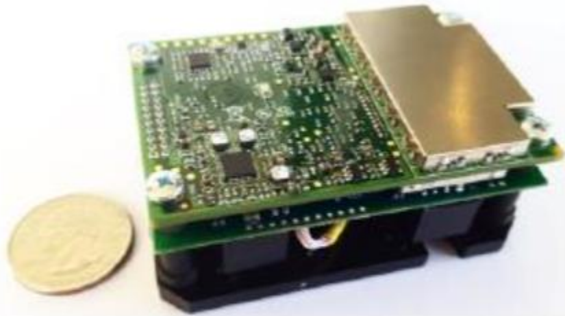
Рисунок 2.20. Модуль INS-B-OEM компанії Inertial Labs (США). Вага 115 грам.
