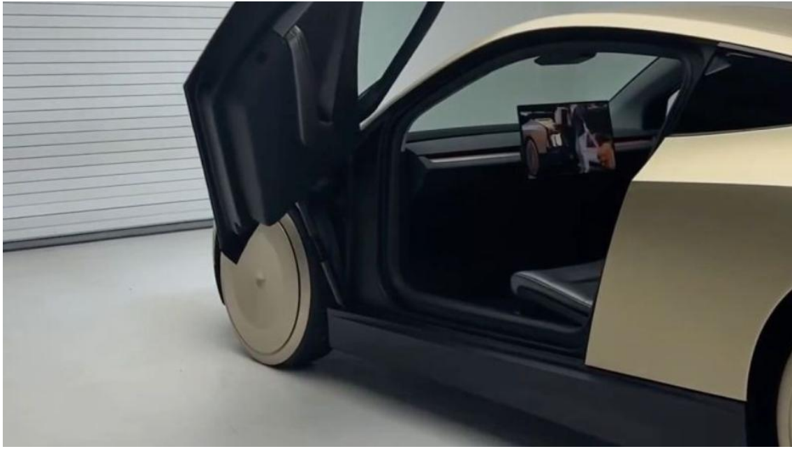
Рис. 1.7. Прототип безпілотного таксі Tesla Cybercab, яка штатно не має руля керування.
