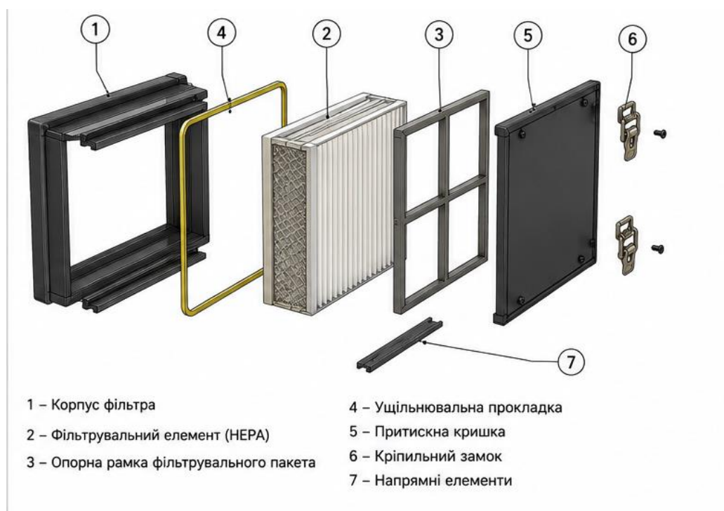
Рис. 2.9. Складальне креслення касетного фільтра з експлікацією елементів.
