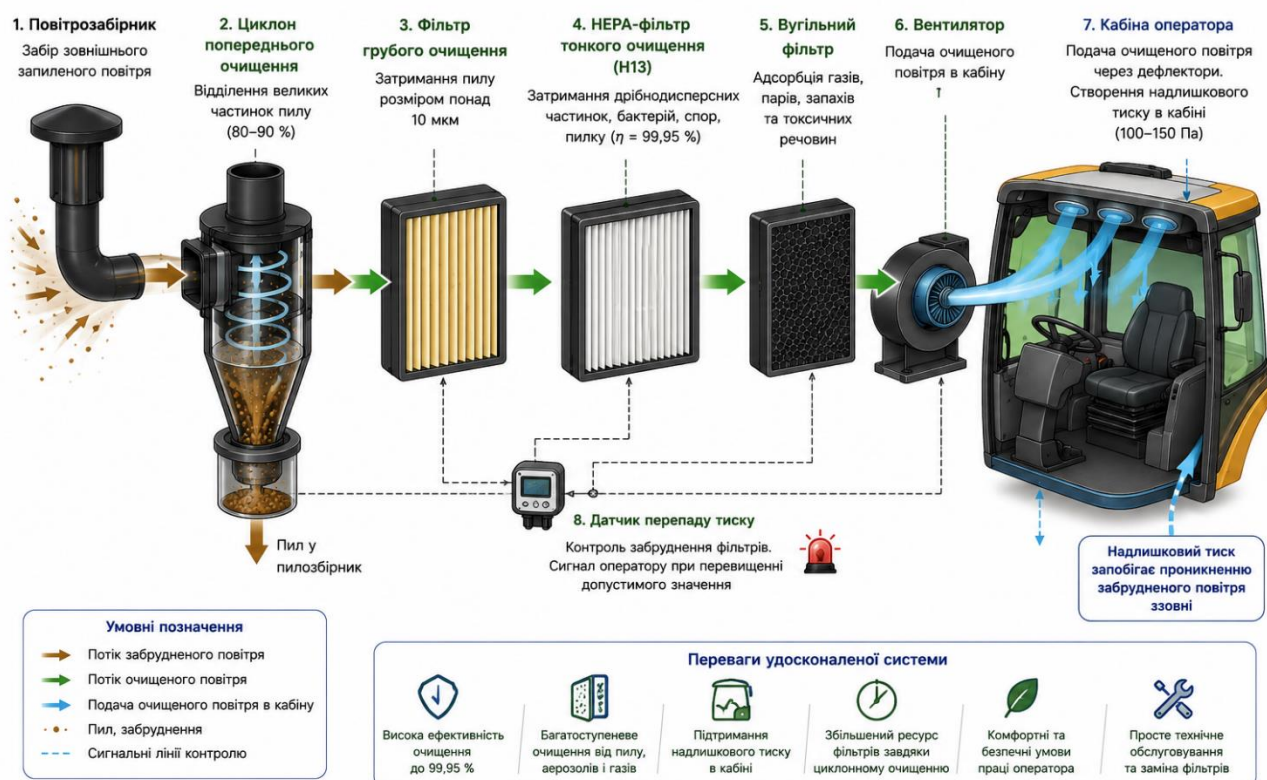
Рис. 2.11 – Принципова схема роботи удосконаленої системи очищення повітря
