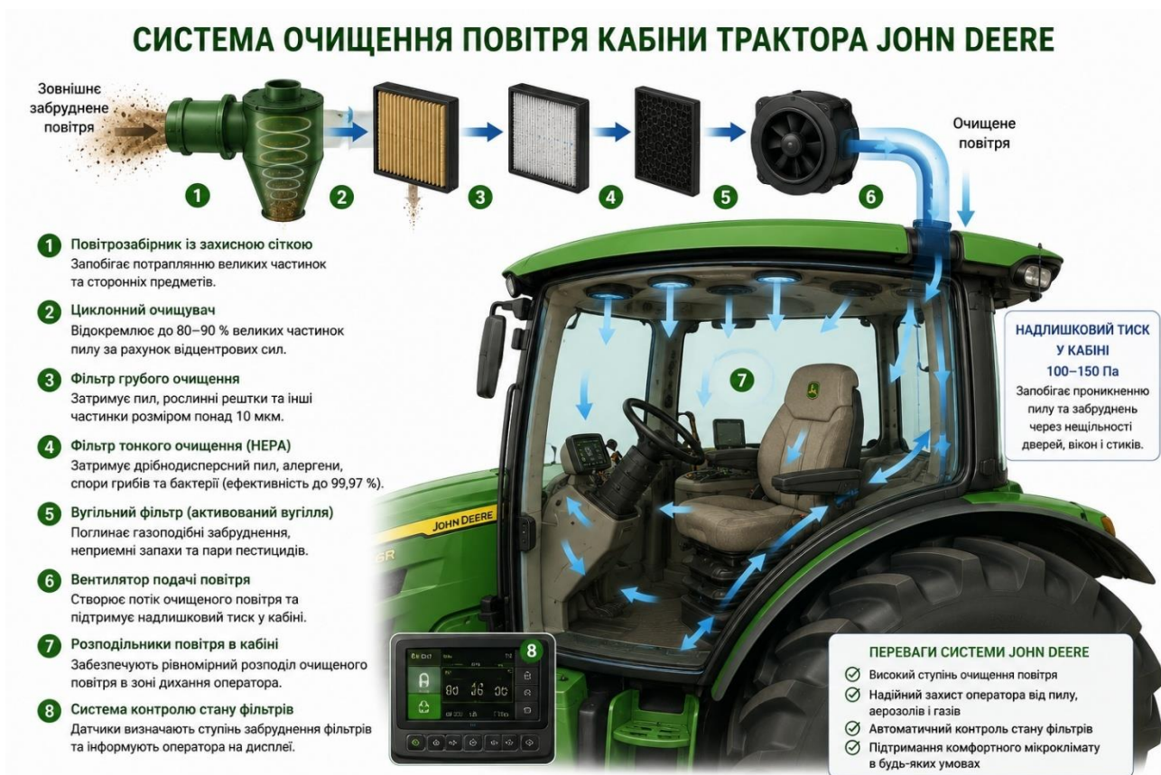
Рис. 1.7 – Система очищення повітря кабіни трактора John Deere.
