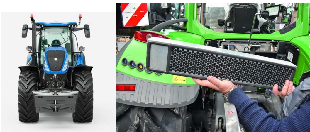
Рис. 1.3. Конструктивна схема системи очищення повітря кабіни сучасного трактора.
