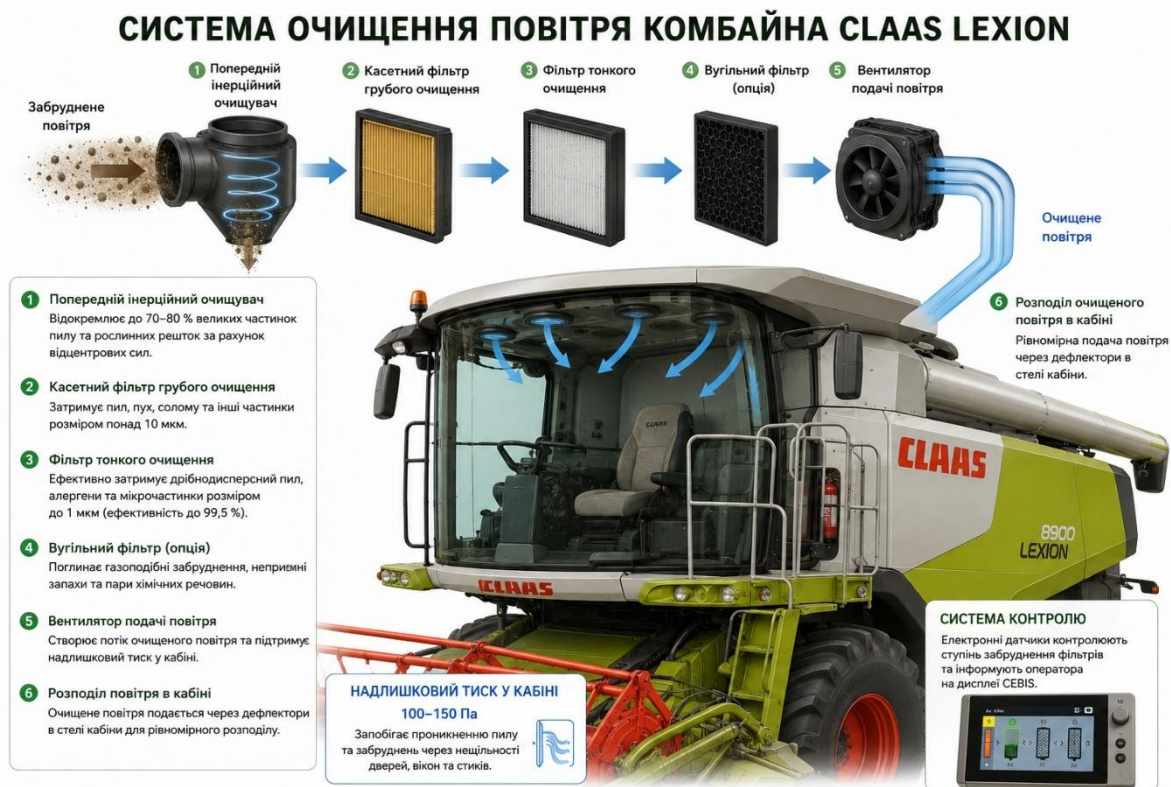
Рис. 1.8 – Система очищення повітря комбайна Claas Lexion.
