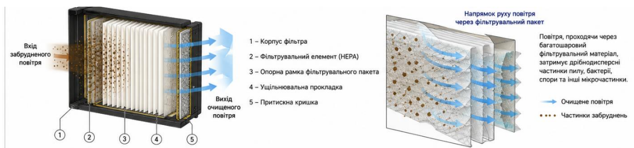
Рис. 2.10 Схема проходження повітря через касетний фільтр
