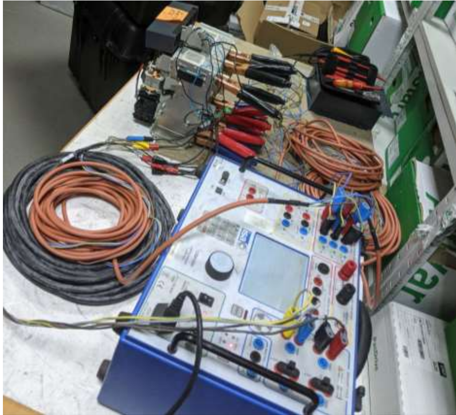
Рис. 5.5 – Виконання випробувань вакуумного вимикача в лабораторних умовах
