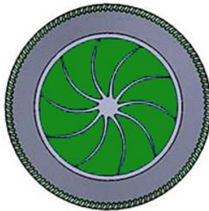
Рис. 2.3 – Загальний вигляд. Схема рухомого абразивного диска з криволінійними борозенками
