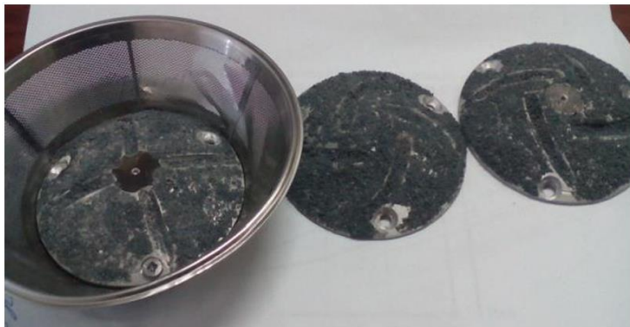
Рис. 3.2. Змінні абразивні диски з криволінійними борозенками
