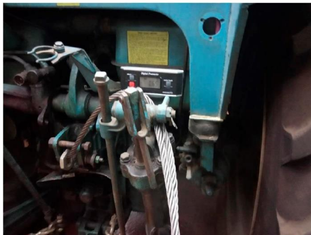
Рисунок 4.3 – Фрагмент експериментальних досліджень з перерозподілу зчпної ваги
