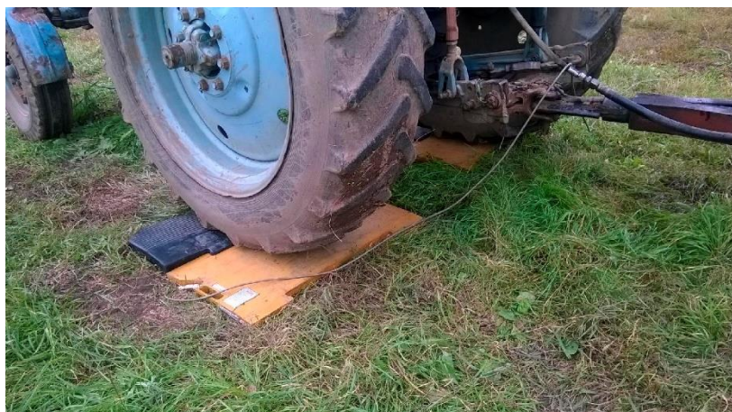
Рисунок 4.1 – Фрагмент експериментальних досліджень з перерозподілу зчїпної ваги
