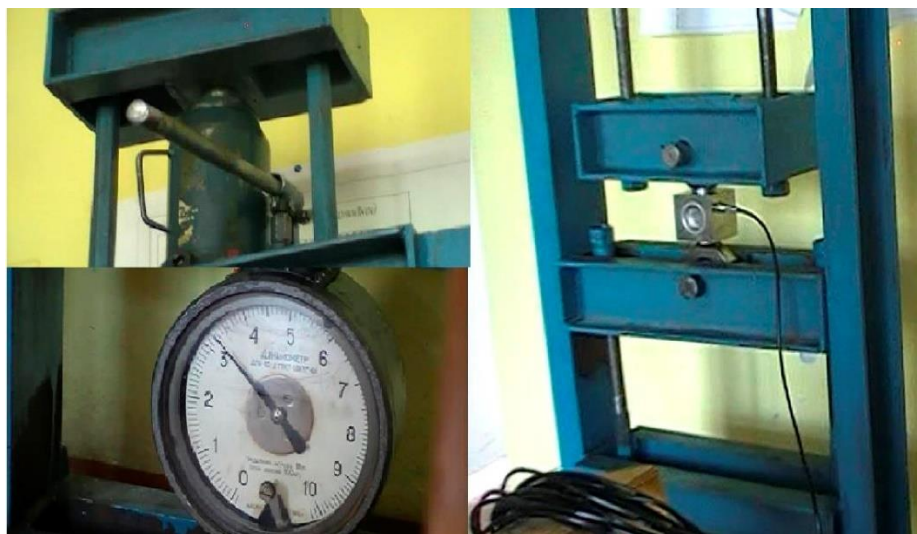
Рисунок 3.14 – Тарування тензометричної ланки
