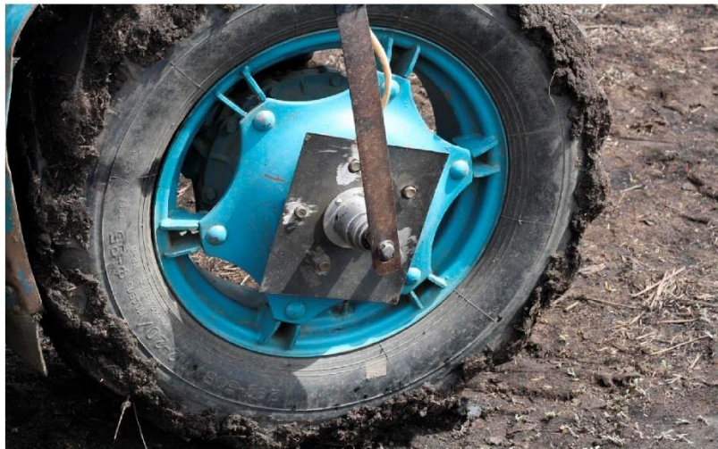
Рисунок 3.9 – Вимірювання пройденого шляху
