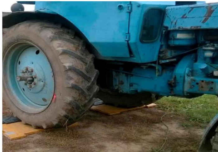
Рисунок 3.10 – Вимірювання ваги, що припадає на ведучі колеса трактора
