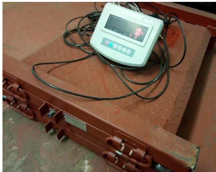
Рисунок 3.16 – Ваги платформні електронні МВСК(В)
