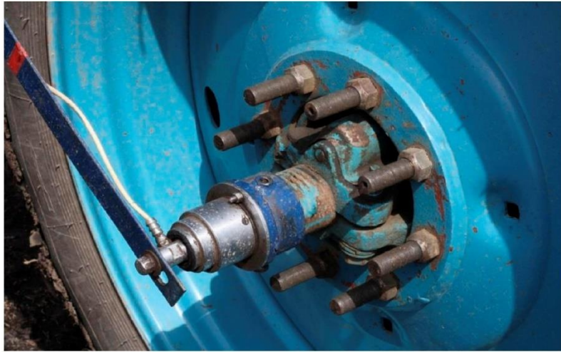
Рисунок 3.7 – Вимірювання частоти обертання ведучих коліс трактора
