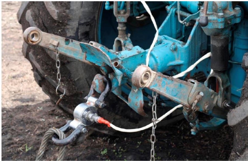
Рисунок 3.8 – Вимірювання тягового зусилля
