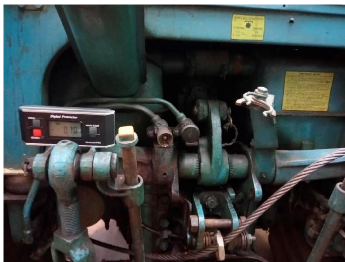
Рисунок 3.12 – Вимірювання поперечного кута нахилу трактора
