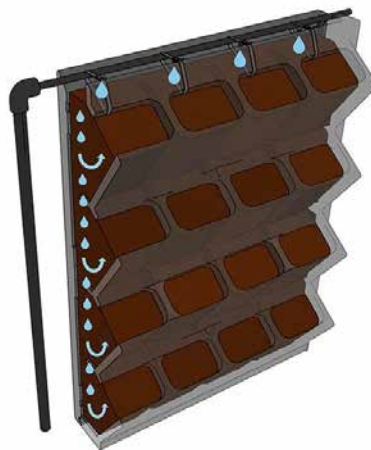
Рис. 4.7. Схема конструкції модульної системи Vertiss Mur Végétal [48].
