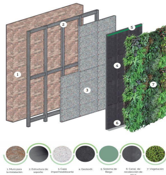
Рис. 4.9. Схема влаштування зеленої стіни [49].
