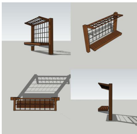
Рис. 4.14. Лава з інтегрованою сітчастою конструкцією для вертикального озеленення (розробка автора).
