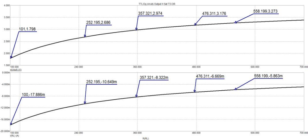
Рис. 4.18. Результати моделювання елемента ТТЛ для високого рівня вихідної напруги і насиченні T_3 в залежності від опору R_L
