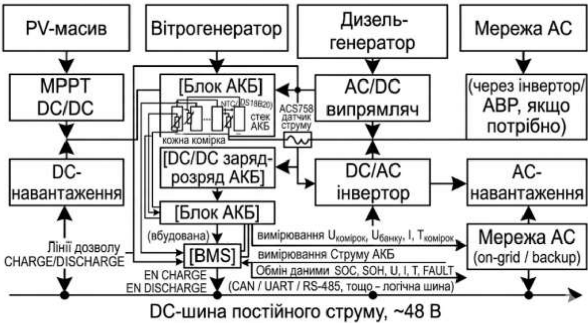
Рис. 1.3. Структурна схема гібридної енергосистеми
