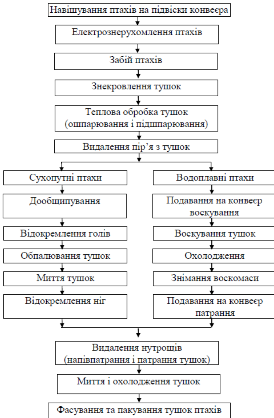
Рис. 23.6. Структурна схема процесу забою і первинної переробки птахів усіх видів
