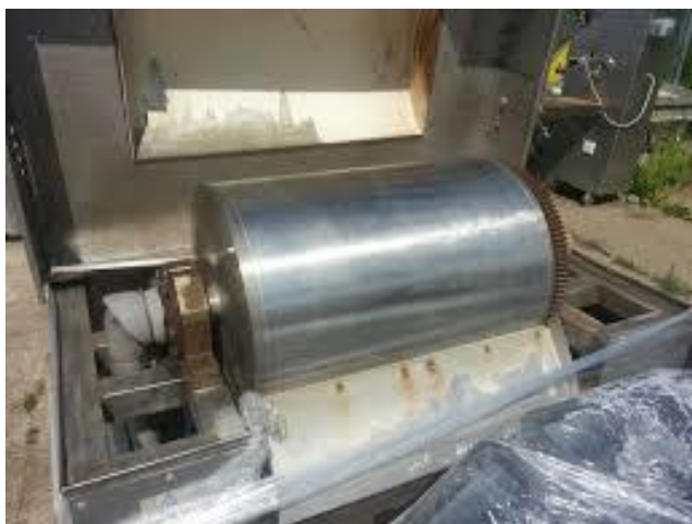
Рис. 19.12. Схема генератора лускатого льоду з горизонтальним барабаном конструкції
