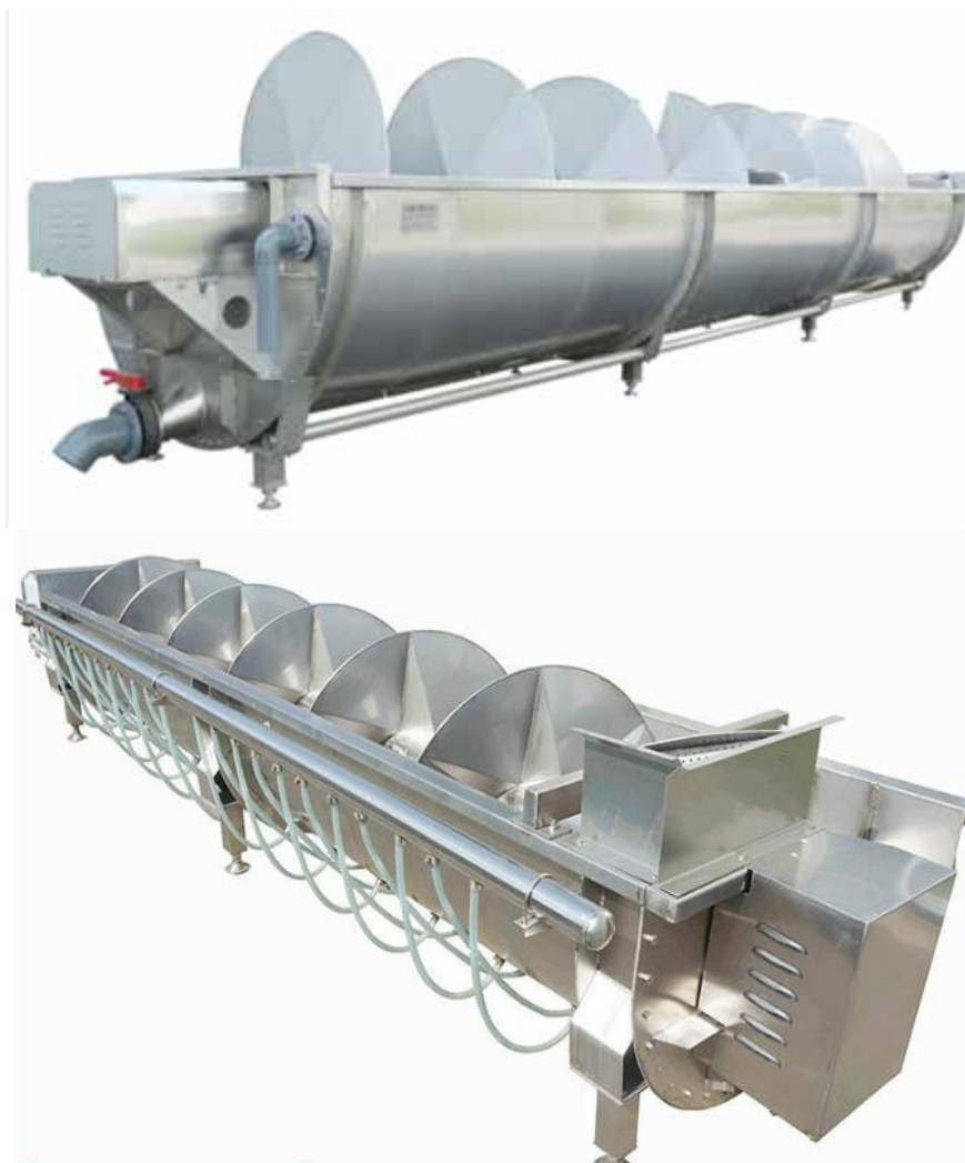
Рис. 19.7. Шнековий охолоджувач для субпродуктів птиці
