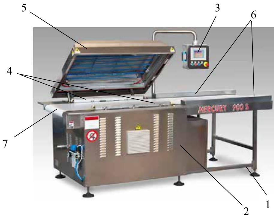
Рис. 22.8. Конвеєрна пакувальна машина: 1 – рама; 2 – корпус, 3 – пульт управління; 4 – зварювальні губки; 5 – кришка; 6 – напрямні; 7 – стрічковий конвеєр
