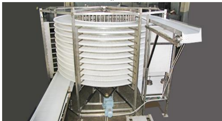
Рис. 19.32. Тунельна кріогенна морозильна установка з спіральним конвеєром: а – схема: 1 – танк для зберігання кріоагенту; 2 – вхід продуктів; 3 – система подачі рідкого кріоагенту; 4 – відсмоктування парів агента; 5 – вихід замороженого продукту; б – загальний вигляд
