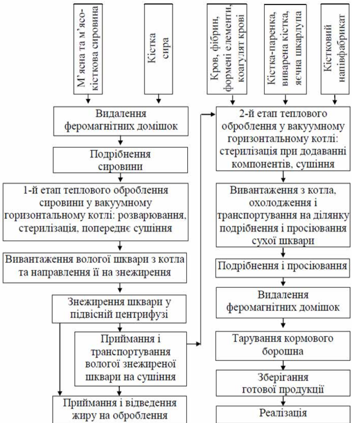
Рис. 27.1. Схема переробки технічної сировини у вакуумних горизонтальних котлах з знежиренням вологої шквари в підвісних центрифугах
