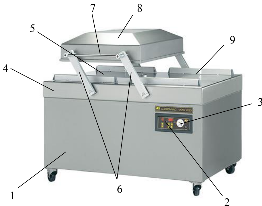
Рис. 22.7. Двокамерна вакуум-пакувальна машина: 1 – рама; 2 – пульт управління; 3 – вакуумметр; 4 – корпус; 5,9 – камери, 6 – важелі; 7 – ручка; 8 – кришка
