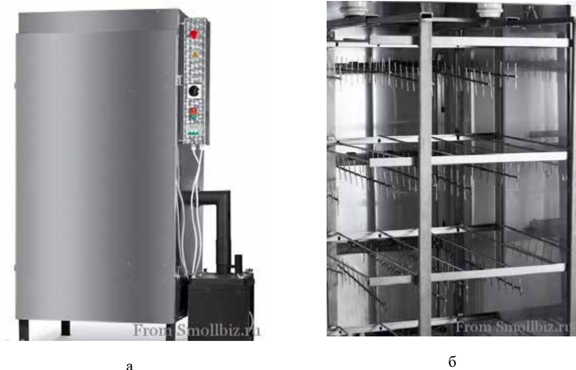
а б Рис. 15.22. Електрокоптильна шафа «Іжиця»: а – загальний вигляд шафи: б – рама шафи
