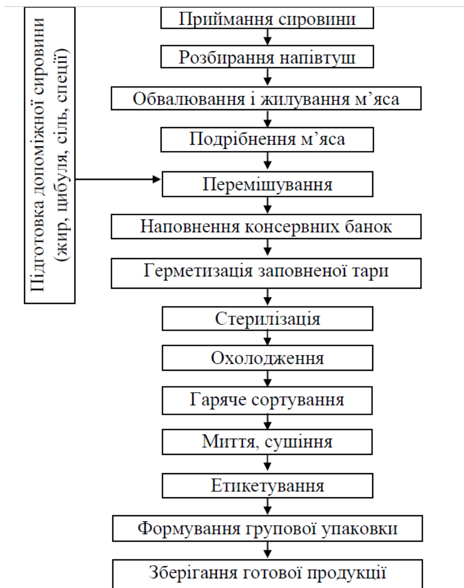
Рис. 25.1. Схема виробництва м'ясних консервів
