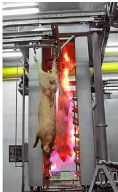
Рис. 13.23. Обпалювальна піч прохідного типу фірми BANSS
