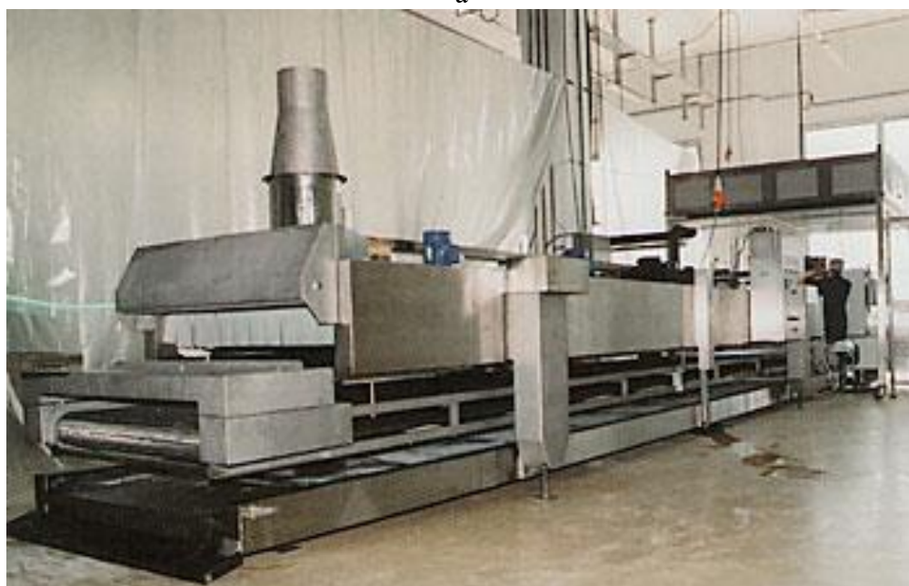
Рис. 19.31. Тунельна кріогенна морозильна установка з горизонтальними конвеєрами: а – схема: 1 – танк для зберігання кріоагенту ; 2 – вхід продуктів; 3 – система подачі рідкого кріоагенту ; 4 – відсмоктування парів аенту ; 5 – вихід замороженого продукту; б – загальний вигляд
