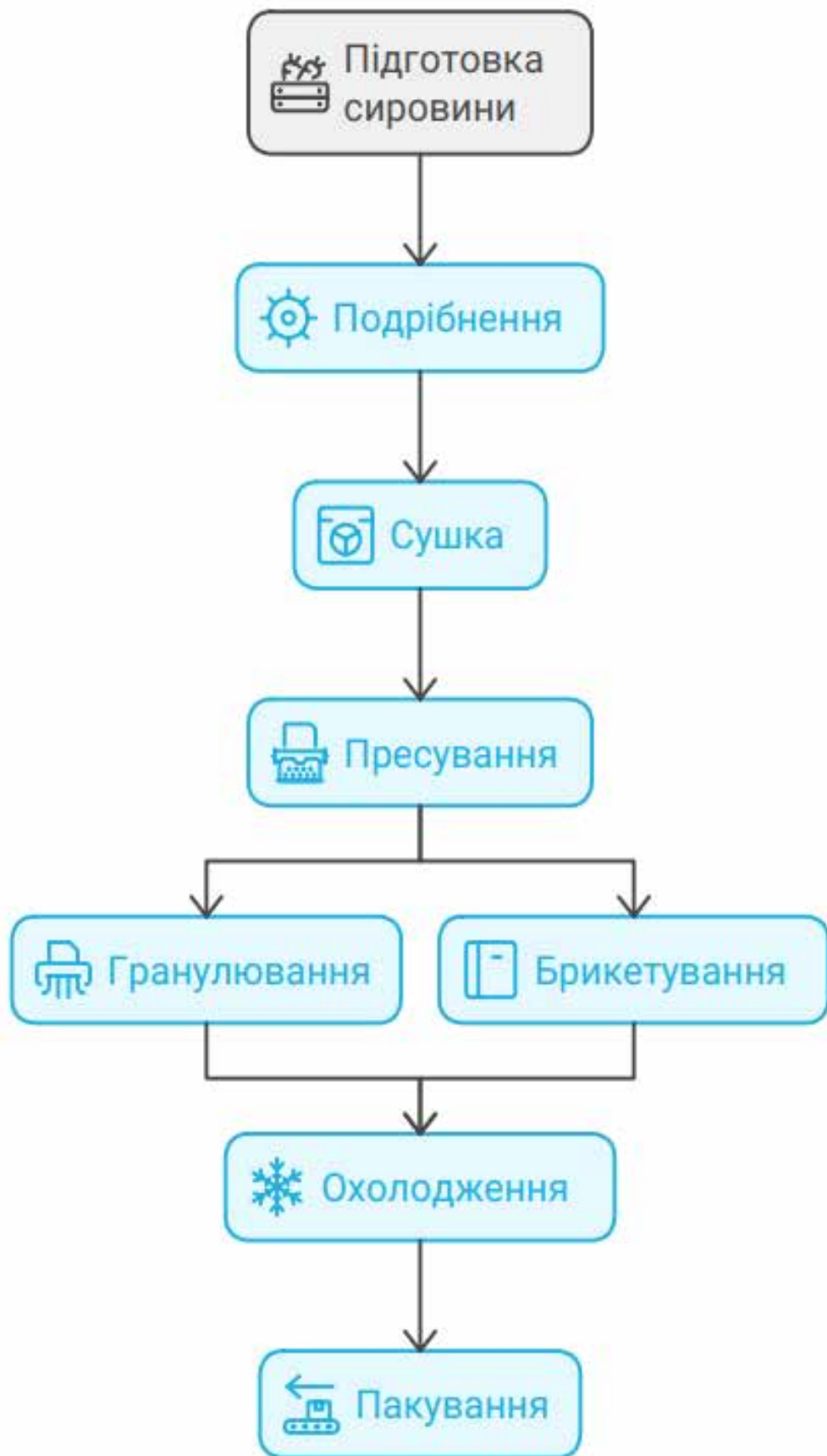
Рис.1.3 Схема технологічного процесу виробництва твердого біопалива [6]
