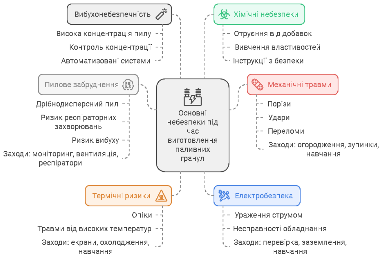
Рис. 4.1 Основні небезпеки під час виготовлення паливних гранул
