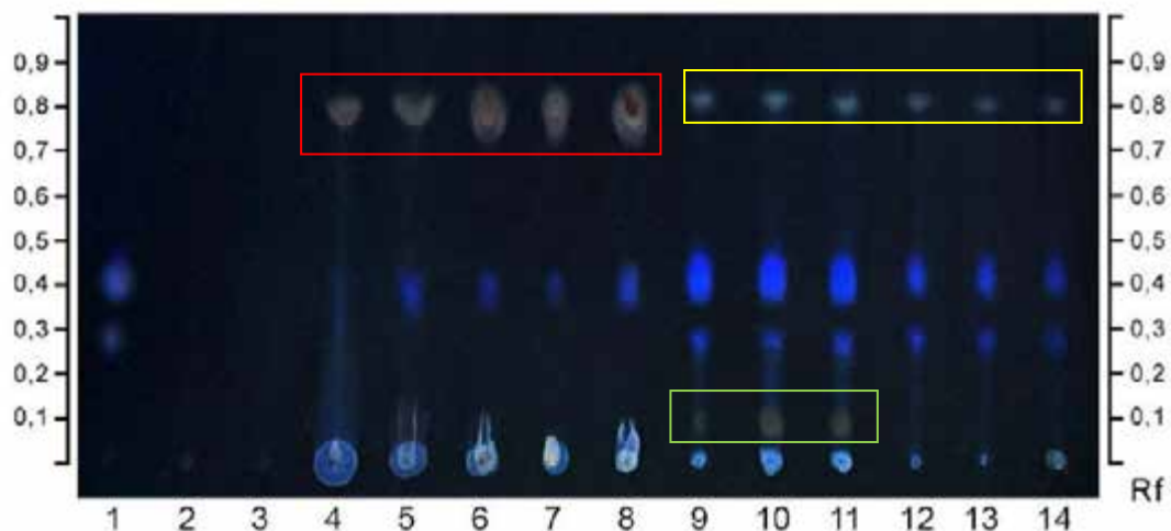
Рис. 3.11. Хроматограма продуктів вторинного синтезу штаму Bacillus subtilis BSFHB за різних умов культивування: на базових ПС Звягінцева (1), КДА (2), Ленді (3); на ПС Звягінцева за додавання розчину ГБХ (0,1%): 4 – контроль, 5 – розведення ГБХ 1 : 100, 6 – 1 : 1000, 7 – 1 : 10 000, 8 – 1 : 100 000; за додавання розчину ТВХ (0,1%) на першу добу культивування: 9 – контроль, 10 – 1 : 1000, 11 – 1 : 10 000, на другу добу культивування: 12 – контроль, 13 – 1 : 1000, 14 – 1 : 10 000
