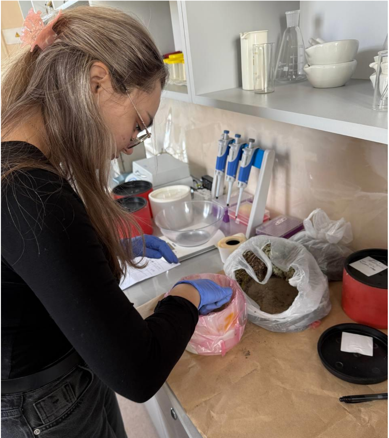
Рисунок 3.6 Відбирання рослинних решток від зразка ґрунту
