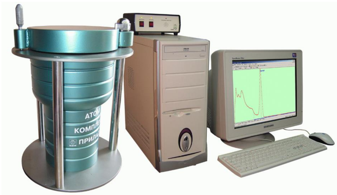
Рис 3.5 Вигляд спектрометра СЕГ- 001 «АКП - С» - 63 виробництва НВП «Атомкомплексприлад» (Київ)
