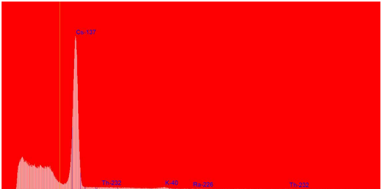
Рисунок 3.12 Спектр гама-випромінювання радіонуклідів в пробах польського гриба
