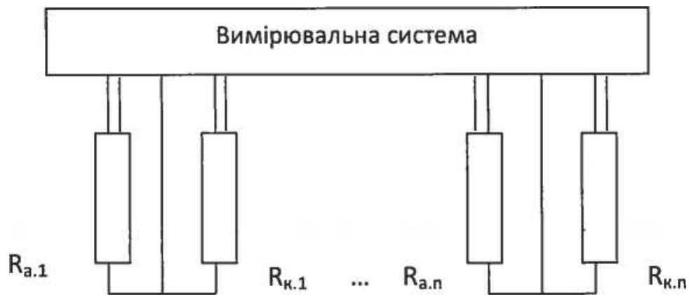
Рис. 2.15. Схема підключення тензорезисторів до вимірювальної системи
