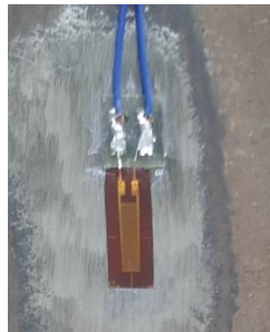
б) Фото тензорезистора на об'єкті
