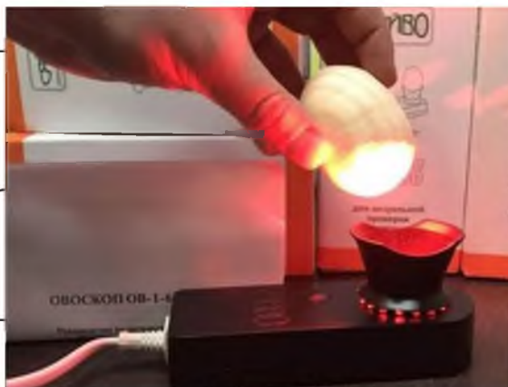
Рис. 1. Овоскоп – прилад для контролю якості харчових яєць, візуальної перевірки якості яєць перед закладкою в інкубатор та в процесі їх інкубації.
