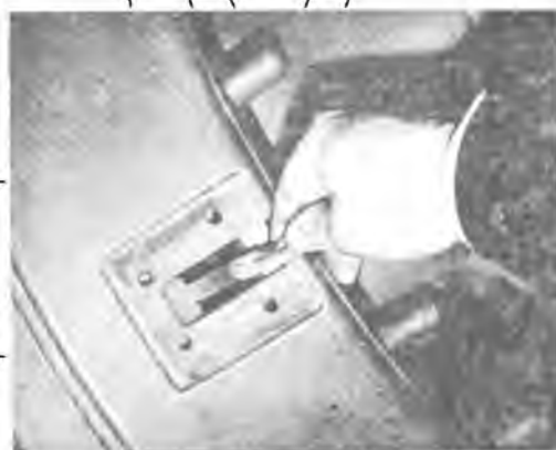
Рис. 5.5. Перевірка зазору між гальмівним барабаном і накладками колодок.
