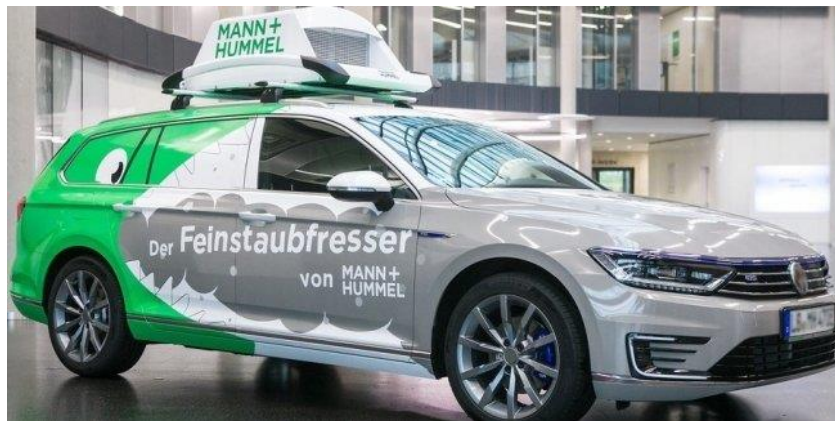
Рис. 1. Фільтр тонкого очищення пиловидних частинок виробництва компанії MANN + HUMMEL, який встановлений на даху кузова автомобіля.
